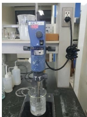
ภาพที่ 25 นำเครื่องโฮโมจีไนเซอร์มาเตรียมกวนสารละลาย
