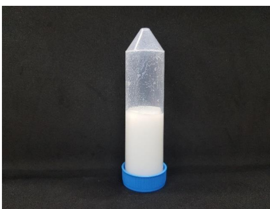
ภาพที่ 26 สารละลายเซลล์ูโลสอสัณฐานที่มีการตรึงซิงค์ไฮดรอกไซด์
