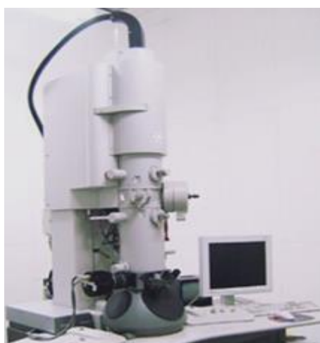
รูปที่ 3.6 กล้องจุลทรรศน์อิเล็กตรอนแบบส่องผ่าน
