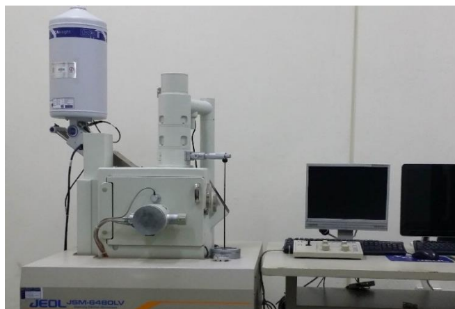
รูปที่ 3.5 กล้องจุลทรรศน์อิเล็กตรอนแบบส่องกราด
