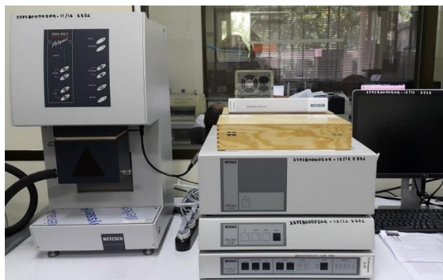
รูปที่ 3.20 เครื่องทดสอบสมบัติเชิงกลพลวัต
