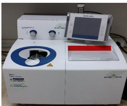
รูปที่ 3.16 เครื่องดิฟเฟอเรนเชียลสแกนนิ่งแคลอริมิเตอร์
