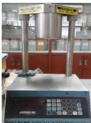
รูปที่ 3.18 เครื่องวัดดรรชนีการหลอมไหล (MFI)
