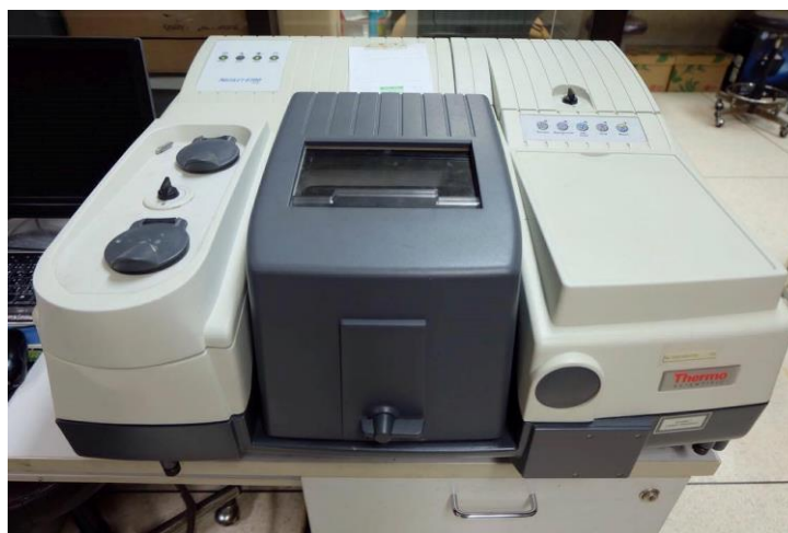
รูปที่ 3.6 เครื่องฟูเรียร์ทรานสฟอร์มอินฟราเรดสเปกโตรมิเตอร์
