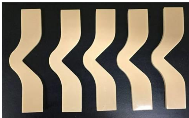
รูปที่ 3.16 ชิ้นงานทดสอบแบบ angle ตามมาตรฐาน ASTM D624
