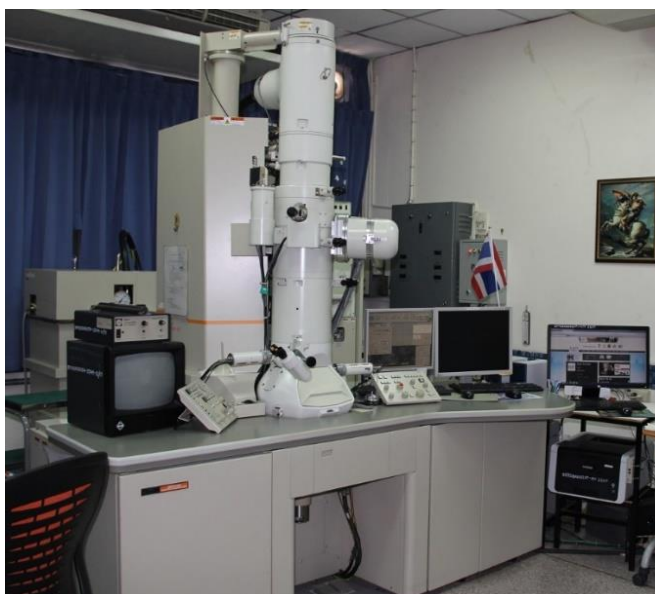
รูปที่ 3.7 กล้องจุลทรรศน์อิเล็กตรอนแบบส่องผ่าน
