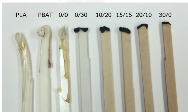
รูปที่ 4.22 ลักษณะชิ้นทดสอบภายหลังการทดสอบหาค่าดรรชนีออกซิเจนจำกัดของ PLA, PBAT, พอลิเมอร์ผสม 70/30 PLA/PBAT และ 70/30 PLA/PBAT คอมพอสิต
