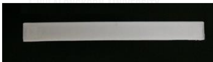
รูปที่ 3.9 ชิ้นทดสอบสมบัติด้านแรงดัดโค้งตามมาตรฐาน ASTM D790
