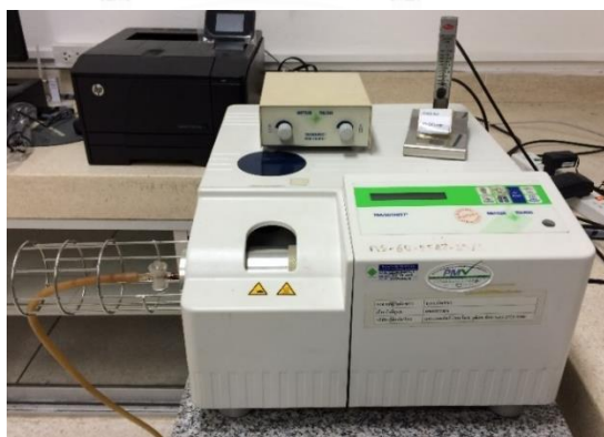
รูปที่ 3.11 เครื่องวิเคราะห์น้ำหนักภายใต้ความร้อน (ทีจีเอ)
