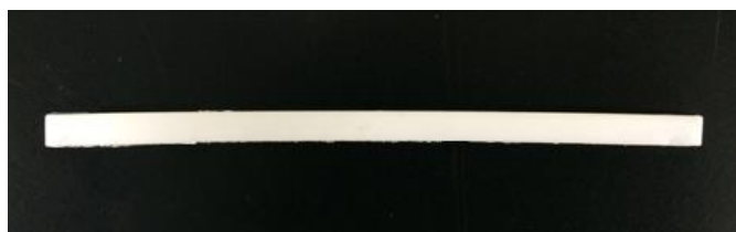
รูปที่ 3.16 ชิ้นทดสอบหาอัตราชึ้นออกซิเจนจำกัดตามมาตรฐาน ASTM D2863
