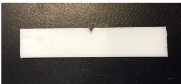
รูปที่ 3.5 ชิ้นทดสอบความทนแรงกระแทกตามมาตรฐาน ASTM D256
