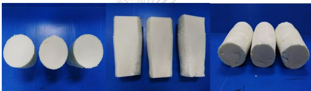
รูปที่ 4.15 ภาพโฟมพอลิยูรีเทนที่เร่งปฏิกิริยาด้วย \text{Cu}(\text{OAc})_2(\text{trien}) : \text{DMCHA} = 0.5:1 หลังจากตัดด้านบนของโฟม (ภาพด้านซ้าย) ด้านข้างของโฟม (ภาพตรงกลาง) และด้านล่างของโฟม (ภาพด้านขวา)
