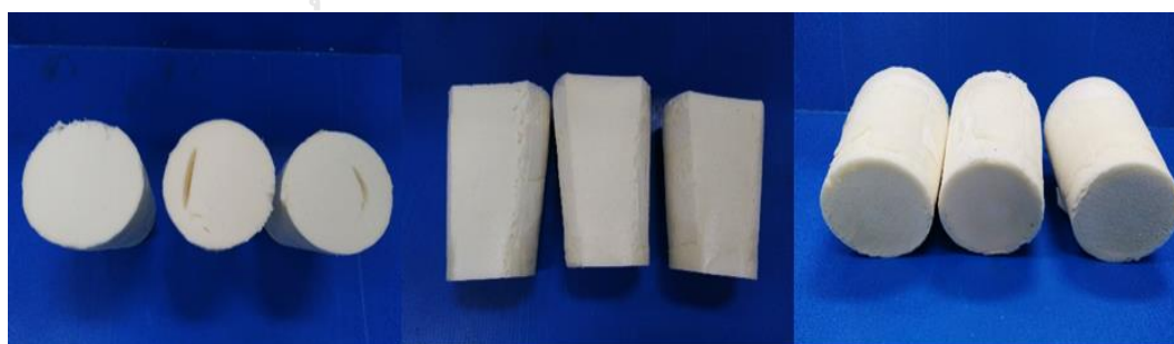
รูปที่ 4.18 ภาพโพลีเมอร์พอลิยูรีเทนที่เร่งปฏิกิริยาด้วย TEDA หลังจากตัดด้านบนของโพลีเมอร์ (ภาพด้านซ้าย) ด้านข้างของโพลีเมอร์ (ภาพตรงกลาง) และด้านล่างของโพลีเมอร์ (ภาพด้านขวา)
