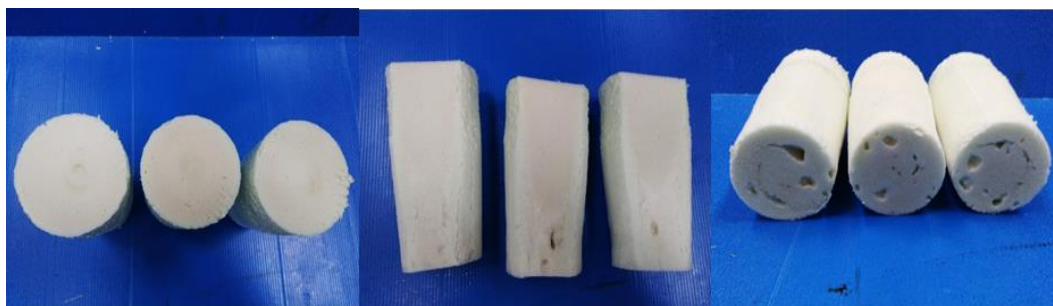
รูปที่ 4.8 ภาพโพลีเมอร์ที่เร่งปฏิกิริยาด้วย \text{Cu}(\text{OAc})_2(\text{en})_2 : DMCHA = 2:1 หลังจากตัด ด้านบนของโพลีเมอร์ (ภาพด้านซ้าย) ด้านข้างของโพลีเมอร์ (ภาพตรงกลาง) และด้านล่างของโพลีเมอร์ (ภาพด้านขวา)
