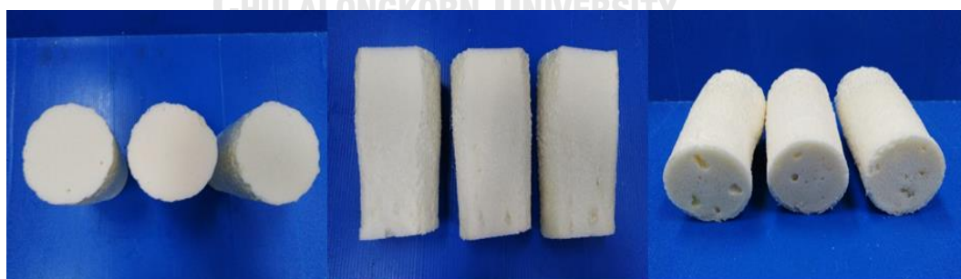
รูปที่ 4.22 ภาพโพลีเมอร์พอลิยูรีเทนที่เร่งปฏิกิริยาด้วย KOct หลังจากตัดด้านบนของโพลีเมอร์ (ภาพด้านซ้าย) ด้านข้างของโพลีเมอร์ (ภาพตรงกลาง) และด้านล่างของโพลีเมอร์ (ภาพด้านขวา)
