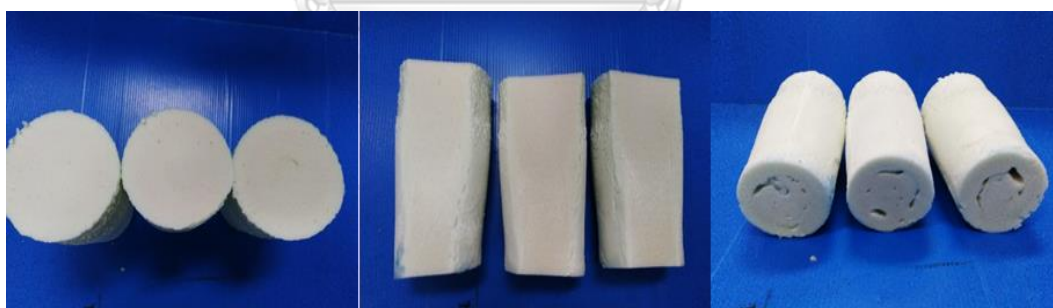
รูปที่ 4.13 ภาพโฟมพอลิยูรีเทนที่เร่งปฏิกิริยาด้วย \text{Cu}(\text{OAc})_2(\text{trien}) : DMCHA = 2:1 หลังจากตัดด้านบนของโฟม (ภาพด้านซ้าย) ด้านข้างของโฟม (ภาพตรงกลาง) และด้านล่างของโฟม (ภาพด้านขวา)
