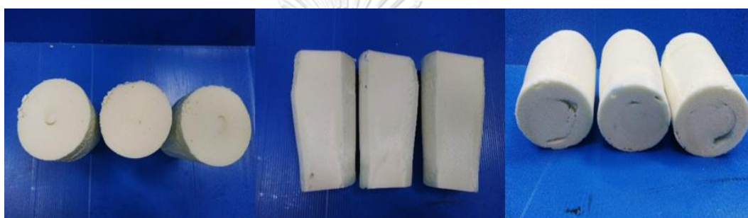
รูปที่ 4.20 ภาพโฟมพอลิยูรีเทนที่เร่งปฏิกิริยาด้วย \text{Cu}(\text{OAc})_2(\text{trien}) : TEDA = 1:1 หลังจากตัดด้านบนของโฟม (ภาพด้านซ้าย) ด้านข้างของโฟม (ภาพตรงกลาง) และด้านล่างของโฟม (ภาพด้านขวา)
