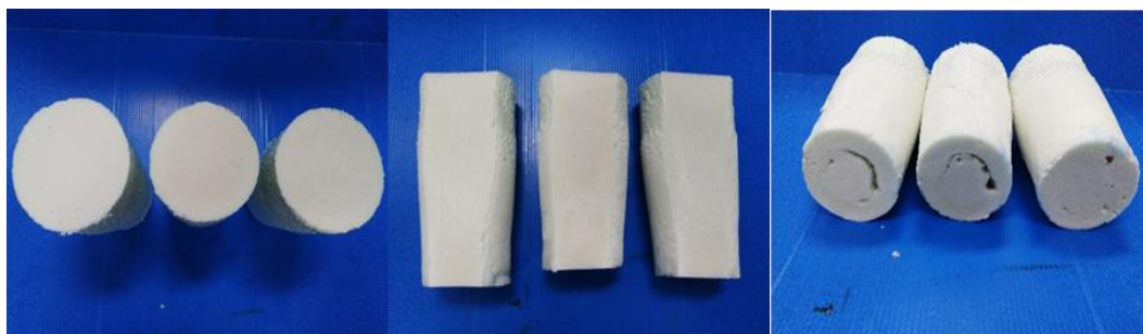
รูปที่ 4.14 ภาพโฟมพอลิยูรีเทนที่เร่งปฏิกิริยาด้วย \text{Cu}(\text{OAc})_2(\text{trien}) : \text{DMCHA} = 1:1 หลังจากตัดด้านบนของโฟม (ภาพด้านซ้าย) ด้านข้างของโฟม (ภาพตรงกลาง) และด้านล่างของโฟม (ภาพด้านขวา)
