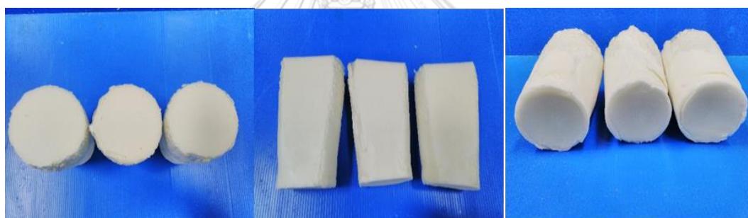
รูปที่ 4.6 ภาพโคมพอลิยูรีเทนที่เร่งปฏิกิริยาด้วย DMCHA หลังจากตัดด้านบนของโคม (ภาพด้านซ้าย) ด้านข้างของโคม (ภาพตรงกลาง) และด้านล่างของโคม (ภาพด้านขวา)
