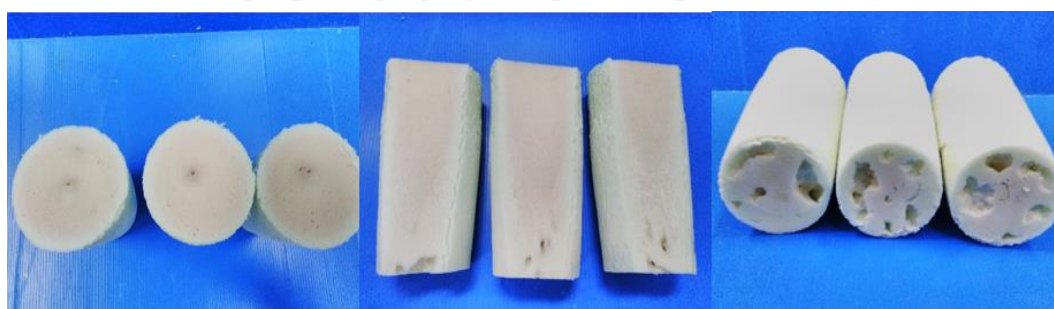
รูปที่ 4.7 ภาพโคมพอลิยูรีเทนที่เร่งปฏิกิริยาด้วย \text{Cu}(\text{OAc})_2(\text{en})_2 หลังจากตัดด้านบนของโคม (ภาพด้านซ้าย) ด้านข้างของโคม (ภาพตรงกลาง) และด้านล่างของโคม (ภาพด้านขวา)
