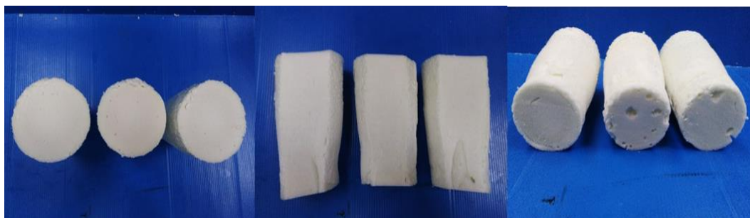
รูปที่ 4.11 ภาพโฟมพอลิยูรีเทนที่เร่งปฏิกิริยาด้วย \text{Cu}(\text{OAc})_2(\text{en})_2 : DMCHA = 0.25:1 หลังจากตัดด้านบนของโฟม (ภาพด้านซ้าย) ด้านข้างของโฟม (ภาพตรงกลาง) และด้านล่างของโฟม (ภาพด้านขวา)
