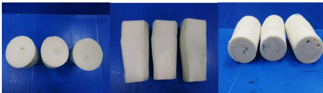
รูปที่ 4.19 ภาพโฟมพอลิยูรีเทนที่เร่งปฏิกิริยาด้วย \text{Cu}(\text{OAc})_2(\text{en})_2 : TEDA = 1:1 หลังจากตัดด้านบนของโฟม (ภาพด้านซ้าย) ด้านข้างของโฟม (ภาพตรงกลาง) และด้านล่างของโฟม (ภาพด้านขวา)
