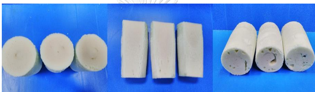
รูปที่ 4.12 ภาพโฟมพอลิยูรีเทนที่เร่งปฏิกิริยาด้วย \text{Cu}(\text{OAc})_2(\text{trien}) หลังจากตัดด้านบนของโฟม (ภาพด้านซ้าย) ด้านข้างของโฟม (ภาพตรงกลาง) และด้านล่างของโฟม (ภาพด้านขวา)
