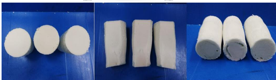
รูปที่ 4.16 ภาพโฟมพอลิยูรีเทนที่เร่งปฏิกิริยาด้วย \text{Cu}(\text{OAc})_2(\text{trien}) : \text{DMCHA} = 0.25:1 หลังจากตัดด้านบนของโฟม (ภาพด้านซ้าย) ด้านข้างของโฟม (ภาพตรงกลาง) และด้านล่างของโฟม (ภาพด้านขวา)
