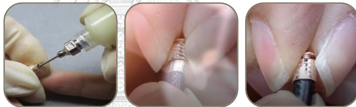
รูปที่ 1-20 การหยอดกาวในรูฟันทำขึ้นงาน และประกอบเข้ากับชิ้นงานสายหนังที่ทำ การบีบประกอบกับแผ่นสแตนเลส
