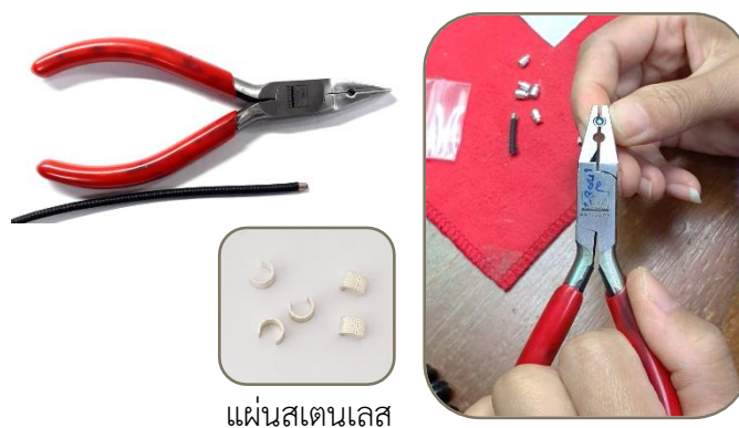
รูปที่ 1-15 การประกอบแผ่นสแตนเลสเข้ากับสายหนัง โดยใช้คีมบีบขนาดเส้นผ่านศูนย์กลาง 3.00 มิลลิเมตร
