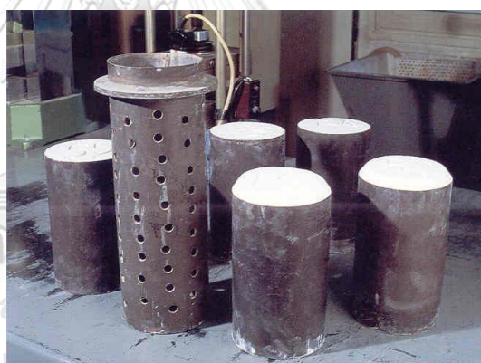
รูปที่ 2-5 ต้นงานเทียนหลังจากเทปูนลงในเบ้าโลหะ
