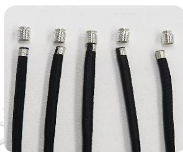
รูปที่ 1-22 ชิ้นงานสำเร็จหลังการทดสอบด้วยเครื่องวัดแรงดึง
