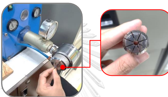
รูปที่ 1-17 การบีบด้วยเครื่องบีบ หัวบีบขนาดเส้นผ่านศูนย์กลาง 2.80 มิลลิเมตร
