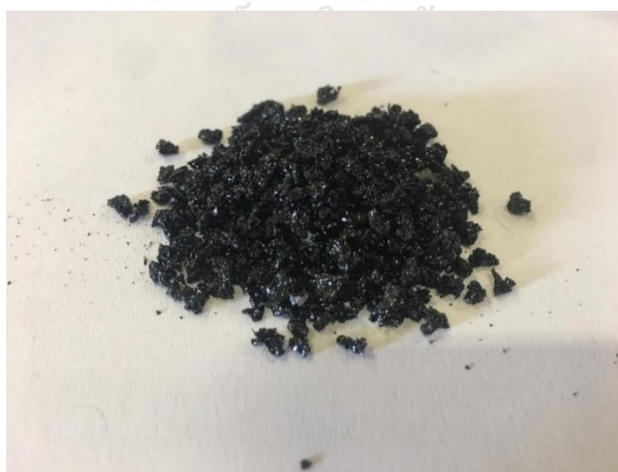
ภาพที่ 3.12 ถ่านจากขวดพอลิเอทิลีนเทอร์ฟทาเลตแบบใส ขนาด 2 – 2.8 มิลลิเมตร
