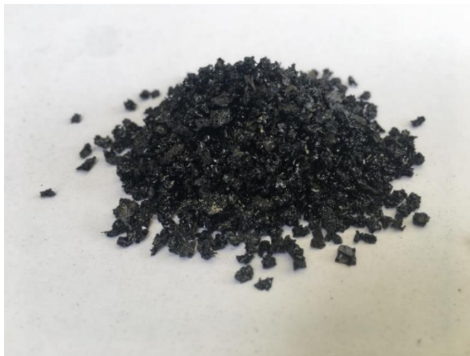
ภาพที่ 3.13 ถ่านจากขุดพอลิเอทิลีนเทรฟทาเลตแบบมีสี ขนาด 2 – 2.8 มิลลิเมตร
