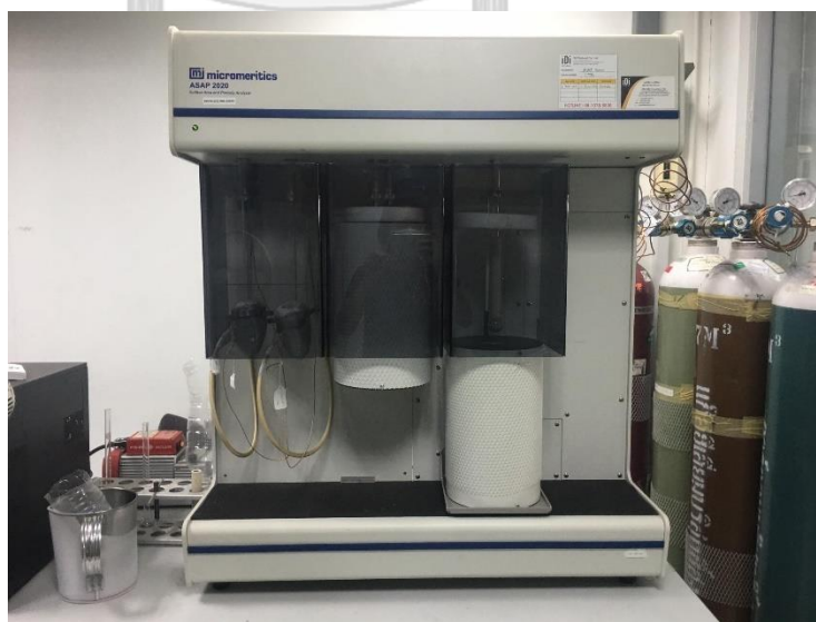
ภาพที่ 3.7 เครื่องวัดพื้นที่ผิวและความเป็นรูพรุนด้วยเทคนิคการวัดการดูดซับไนโตรเจน
