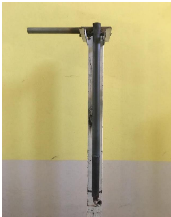
ภาพที่ 3.2 เครื่องปฏิกรณ์สำหรับทำการกระตุ้น
