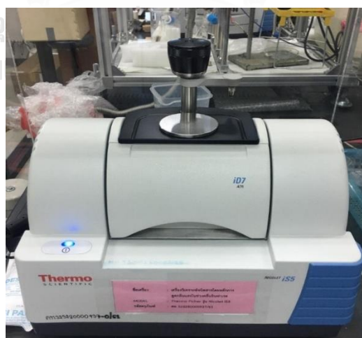
ภาพที่ 3.9 เครื่องฟูเรียร์ทรานส์ฟอร์มอินฟราเรดสเปกโทรสโคปี
