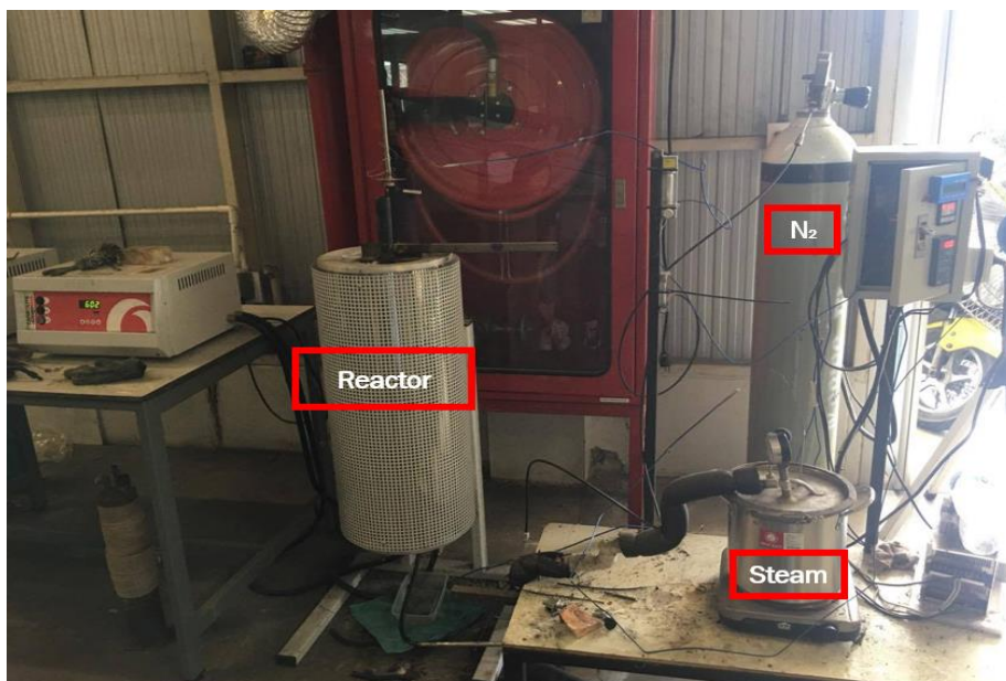
ภาพที่ 3.3 ชุดกระตุ้นประกอบด้วยเตาเผาให้ความร้อนแบบแนวตั้ง เครื่องปฏิกรณ์สำหรับการกระตุ้น หม้อต้มไอน้ำ ก๊าซไนโตรเจน และเทอร์โมคัปเปิล
