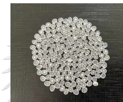
รูปที่ 2.14 ตัวอย่างเม็ดพลาสติกชนิดพอลิโพรพิลีนที่ใช้ในการทดลอง
