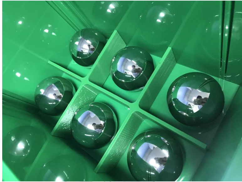
รูปที่ 3.32 หัวสะเกโทกเทียมที่ผลิตจาก โคบอลโครเมียม หลังการขัดผิวที่ได้ค่าตามมาตรฐาน
