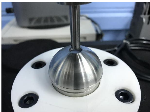
รูปที่ 4.26 ชุดทดลองที่เตรียมไว้ก่อนการถอด liner ออกจาก shell
