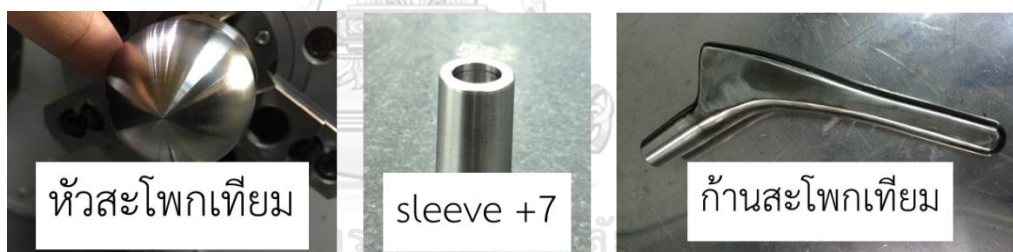
รูปที่ 3.15 หัวสะโพกเทียม คอนเนคเตอร์และก้านสะโพกเทียมที่ผลิตเพื่อนำมาทดสอบความล้าตามมาตรฐาน
