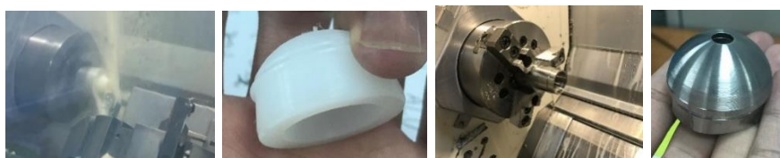
รูปที่ 4.24 ตัวอย่างขั้นตอนการผลิต shell และ liner
