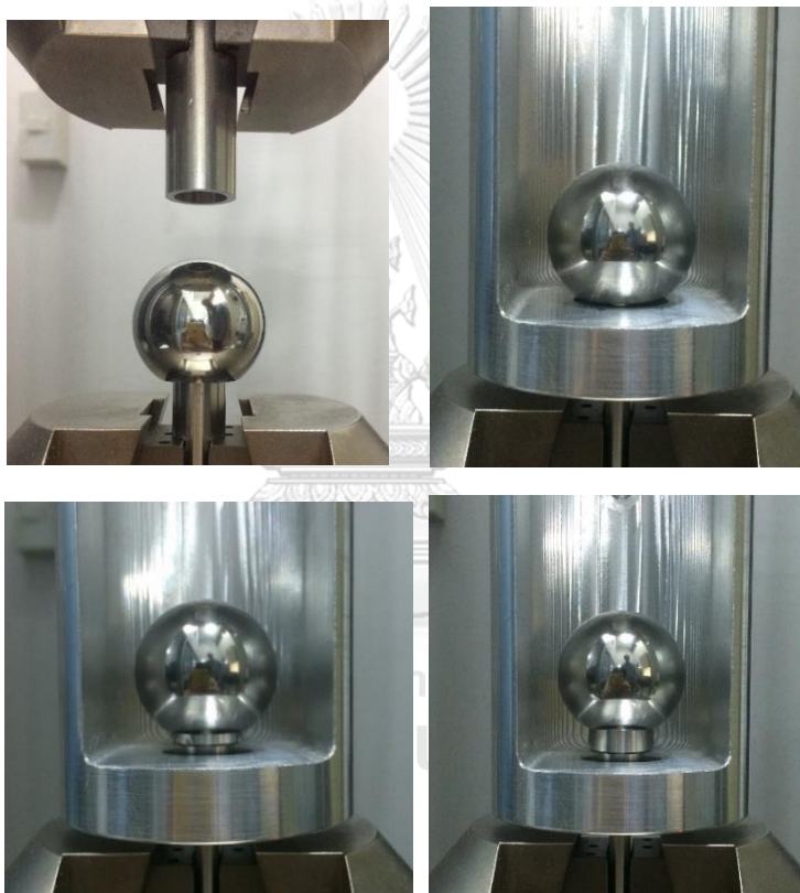
รูปที่ 3.23 ตัวอย่างการสวมชุดอุปกรณ์ทดสอบ ISO7206-10 static tension
