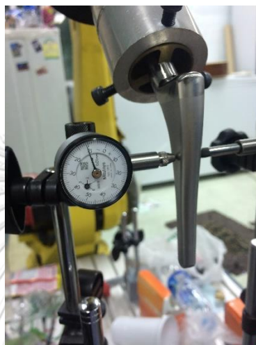
รูปที่ 3.19 การตั้งค่ามุมเอียงของก้านสะโพกเพื่อนำมาทดสอบตามมาตรฐาน
