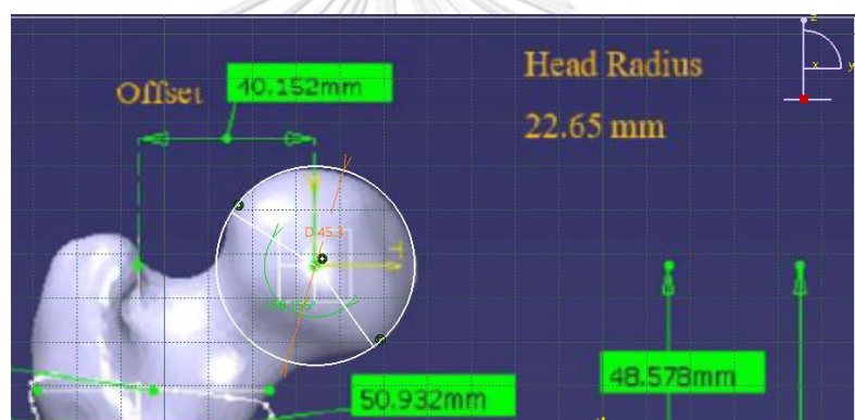
รูปที่ 3.1 ตัวอย่างการวัดองศาพื้นผิวที่เป็นทรงกลมของหัวสะโพก
