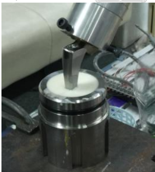
รูปที่ 3.20 ลักษณะการจับก้านสะโพกเทียมด้วย แขนกล robot เพื่อรอ bone cement แข็งตัว
