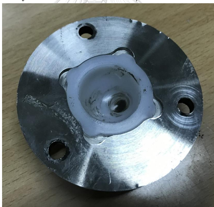
รูปที่ 4.40 liner หลังการทดสอบครบ 1,000,000 รอบ
