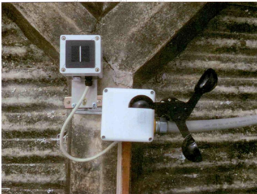
รูปที่ 3-5 การติดตั้งอุปกรณ์วัดค่าความเข้มแสงอาทิตย์และอัตราเร็วลม
