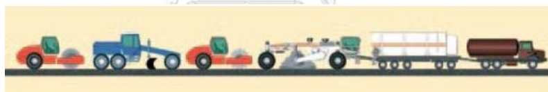
รูปที่ 3 การทำงานของเครื่องจักร Recycler ที่มา : (Wirtgen, 2010)
