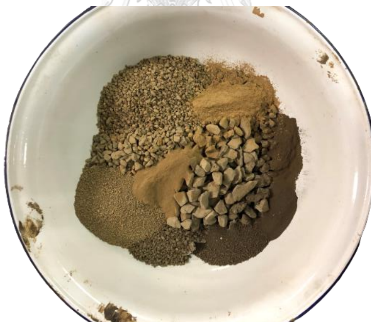
รูปที่ 22 ขนาดคละมวลรวมระหว่าง RAP:RCR ในอัตราส่วน 25:75
