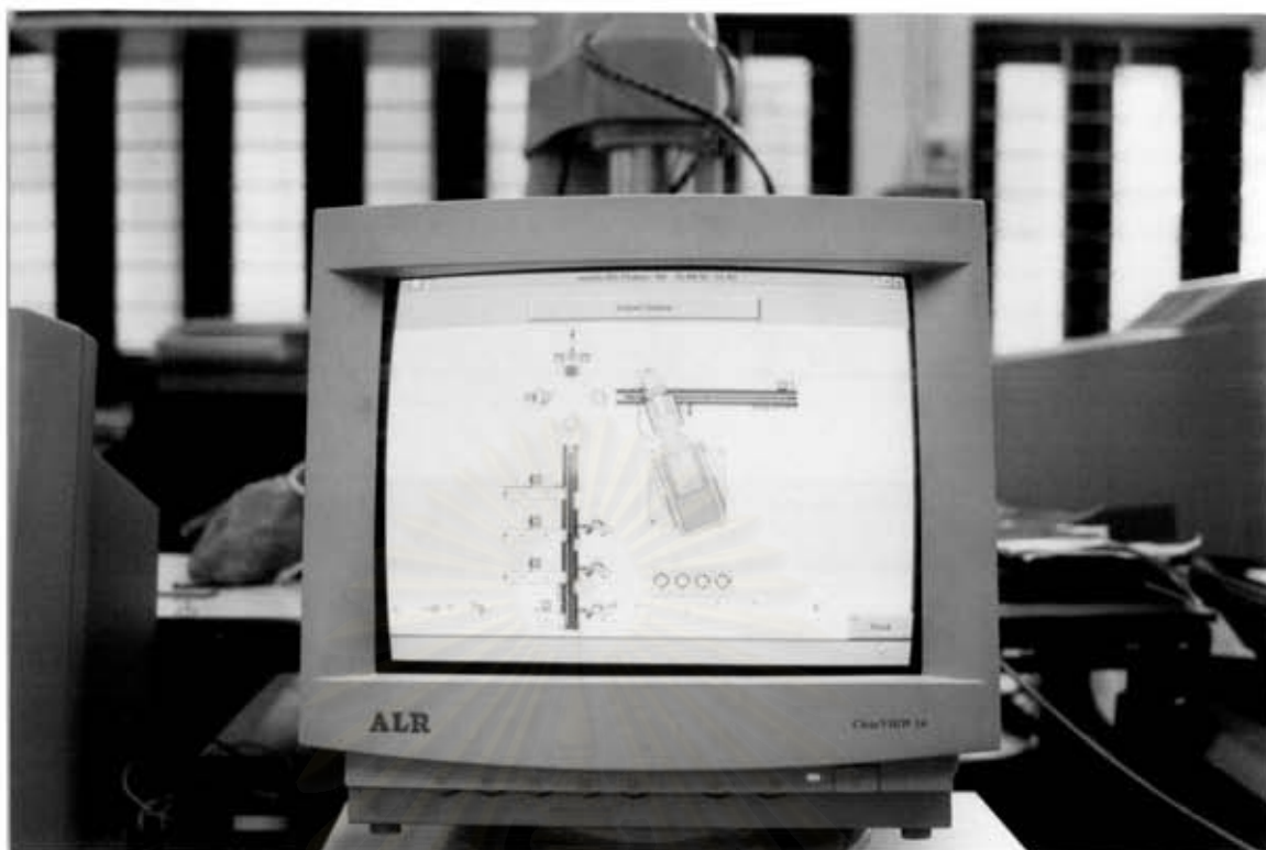
รูปที่ 2.10 แสดงการดูสภาวะการทำงานของสถานีติดตั้งแขนกลด้วย Visualisation Software
