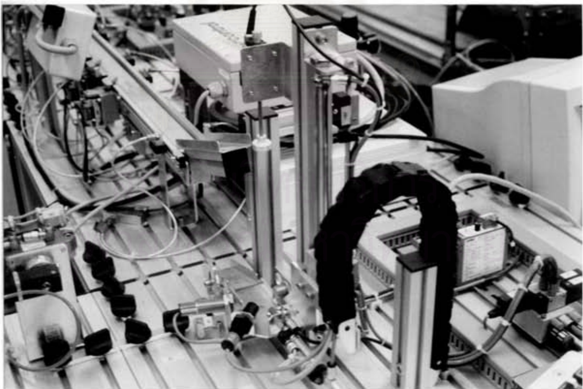
รูปที่ 2.3 แสดงลักษณะของสถานีทดสอบชิ้นงาน
