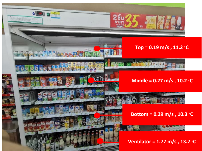
รูปที่ ค.6 ตำแหน่งการวัดค่าความเร็วลมและอุณหภูมิของตู้เย็นแบบประตูเปิด สำหรับแช่ผลิตภัณฑ์นม (ชุดที่ 6)
