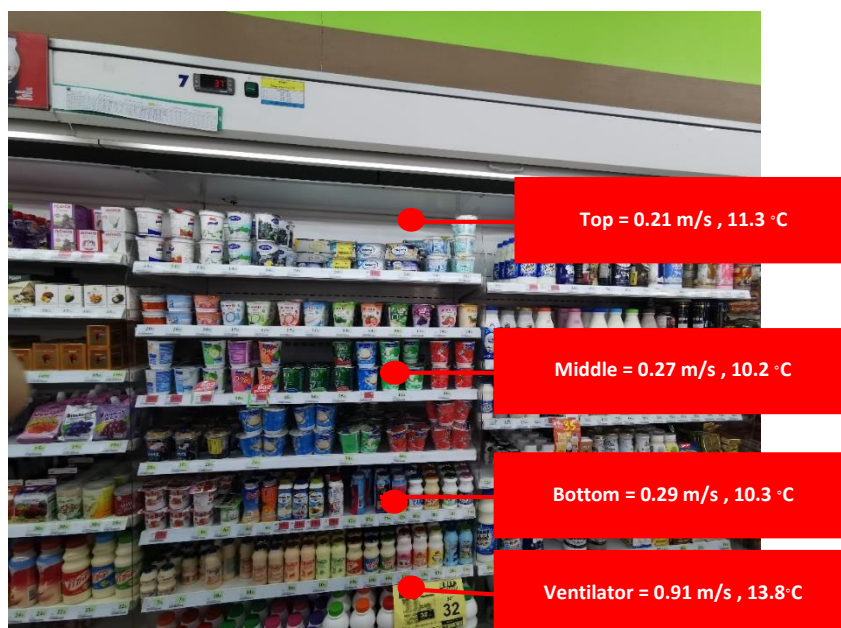
รูปที่ ค.7 ตำแหน่งการวัดค่าความเร็วลมและอุณหภูมิของตู้เย็นแบบประตูเปิด สำหรับแช่โยเกิร์ต (ชุดที่ 7)
