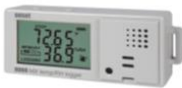
รูปที่ 4.27 อุปกรณ์การตรวจวัดค่าอุณหภูมิและความชื้นสัมพัทธ์
