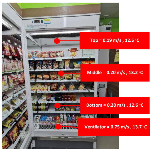
รูปที่ ค.9 ตำแหน่งการวัดค่าความเร็วลมและอุณหภูมิของตู้เย็นแบบประตูเปิด สำหรับแช่อาหารพร้อมรับประทาน (ชุดที่ 9)
