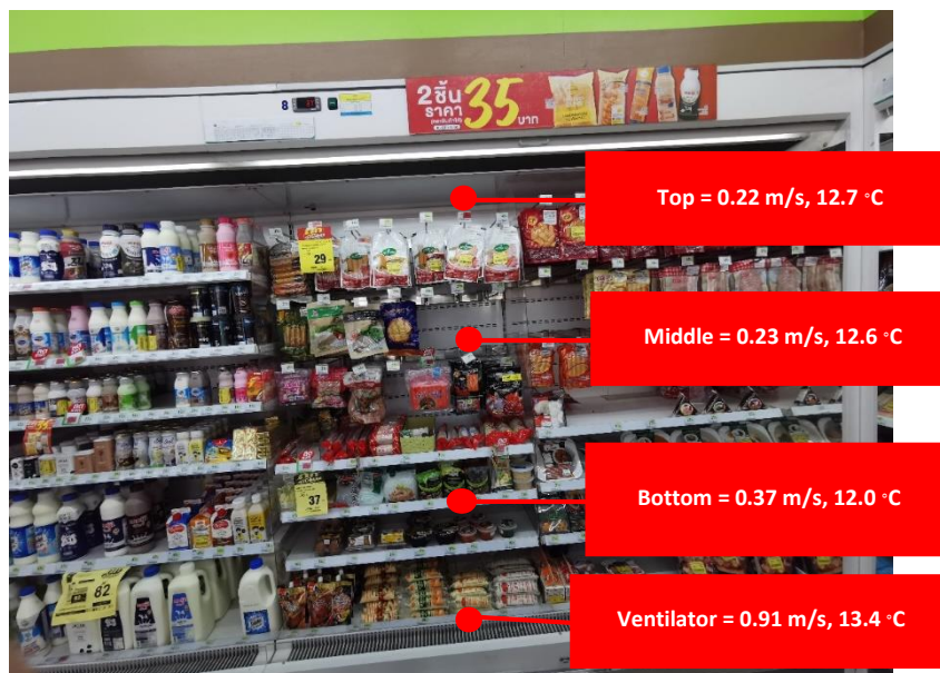
รูปที่ ค.8 ตำแหน่งการวัดค่าความเร็วลมและอุณหภูมิของตู้เย็นแบบประตูเปิด สำหรับแช่อาหารพร้อมรับประทาน (ชุดที่ 8)
