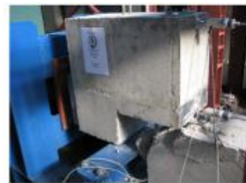
รูปที่ 2.35 การเปรียบเทียบพฤติกรรมของจุดเชื่อมต่อระหว่างการติดตั้งแผ่นเหล็กเสริมด้านข้างของคาน กับคานที่ไม่ได้ติดตั้งแผ่นเหล็ก (Psycharis & Mouzakis, 2012)
