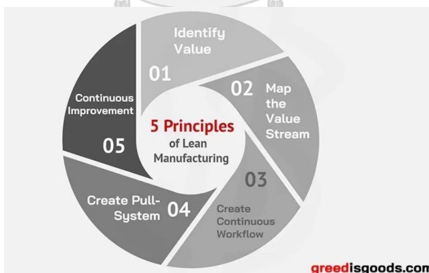
รูปที่ 2.1 แสดงหลักการพื้นฐานของการผลิตแบบลีน 5 ประการ (5 Leans Principles) [4]
