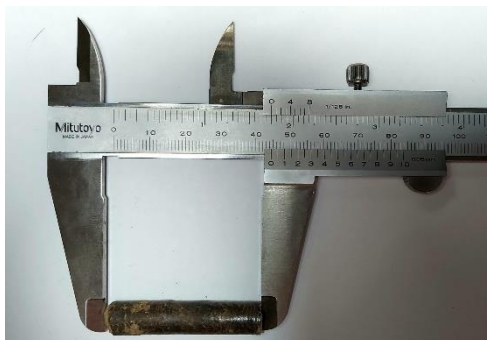
รูปที่ 3.17 การวิเคราะห์ความยาวเฉลี่ยของเชือกเพลิงอัดเม็ด
