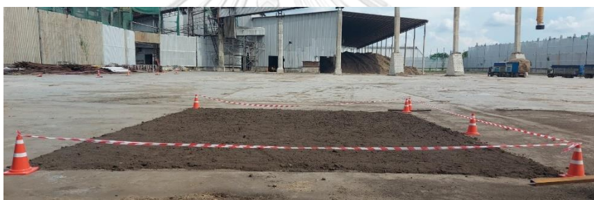
รูปที่ 1.4 การลดความชื้นกากหม้อกรองด้วยการตากแดด
