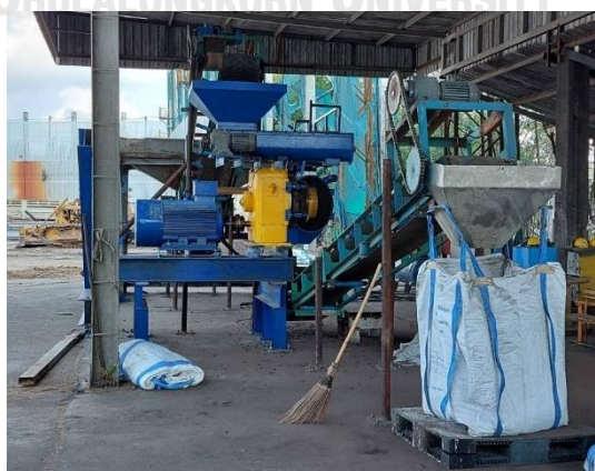
รูปที่ 1.5 การอัดขึ้นรูปกากหม้อกรองด้วยเครื่องอัดเม็ดชีวมวล
