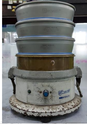
รูปที่ 3.13 เครื่องร่อนและตะแกรงร่อนมาตรฐาน ขนาดรู 3.15 mm
