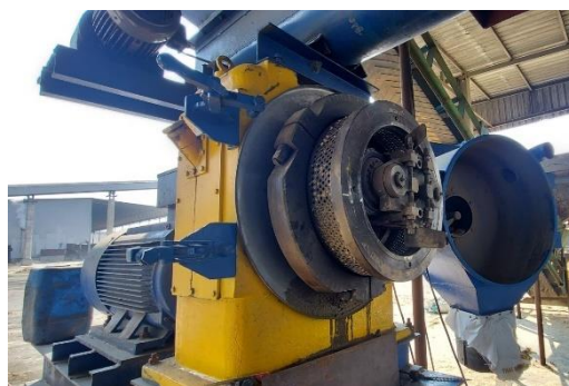
รูปที่ 3.6 เครื่องอัดเม็ดแบบหัวอัตรวงแหวนหรือแนวตั้ง
