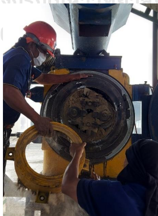
รูปที่ 4.2 การซ่อมบำรุงเครื่องอัดเม็ดชีวมวลแบบวงแหวน
