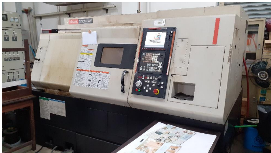
รูปที่ 3.4 เครื่องกลึงซีเอ็นซีชนิด 4 แกน
