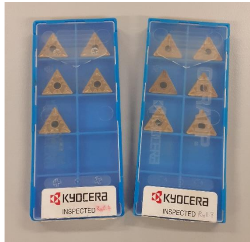
รูปที่ 3.2 ตัวอย่างเม็ดมีดมุมคายเศษโลหะ -6: (ซ้าย) รัศมีงมกมิต 0.4 (ขวา) รัศมีงมกมิต 0.8
