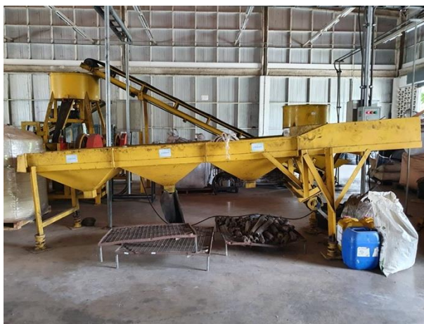
ภาพที่ 3.2 เครื่องคัดขนาดวัตถุบดผ่านซาร์ที่ขนาด 2 – 5 มิลลิเมตร
