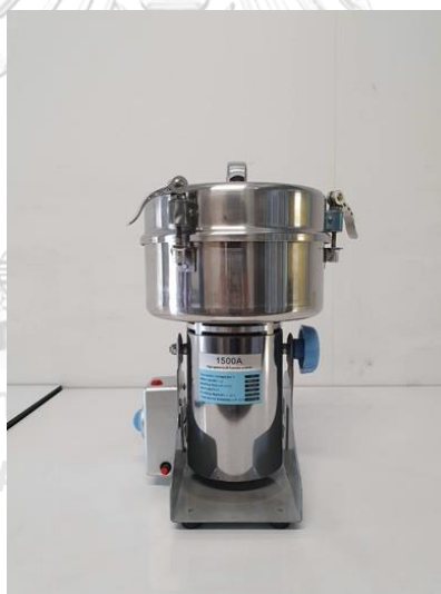
ภาพที่ 3.1 เครื่องบดชีวมวลประเภทหยาบและละเอียด
