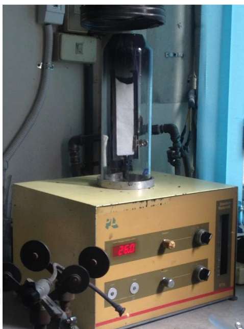
รูปที่ 3.15 เครื่องทดสอบหาค่า Limiting oxygen indexer ของบริษัท Stanton Redcroft Ltd
