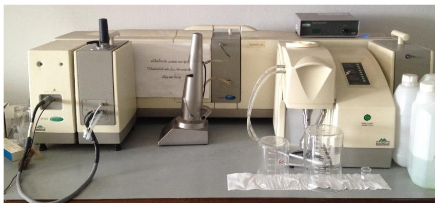
รูปที่ 3.10 เครื่อง Laser Particle Size Distribution Analyzer ของบริษัท Malvern รุ่น Mastersizer 2000 และหน่วยกระจาย Hydro 2000SM
