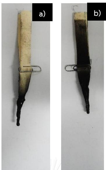
รูปที่ 4.135 ภาพถ่ายของผ้าพอลิเอสเตอร์หลังการเผาไหม้ที่ตกแต่งด้วย a) ไม่ตกแต่ง และ b) control-f
