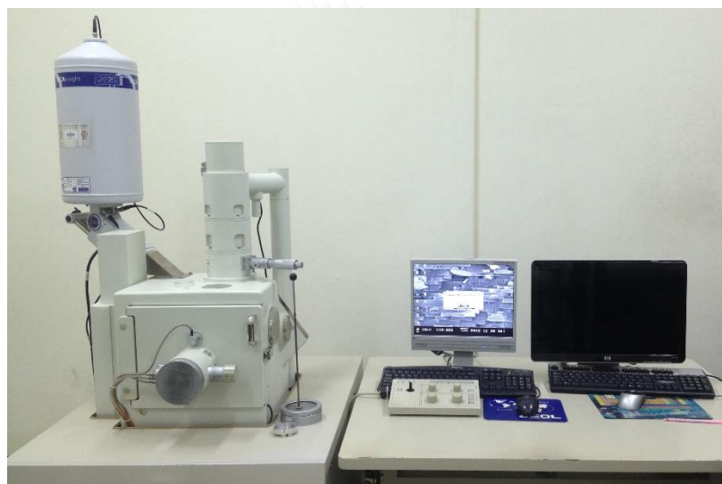
รูปที่ 3.7 กล้องจุลทรรศน์อิเล็กตรอนแบบส่องกราด ของบริษัท JEOL., Ltd. รุ่น JSM 6400 LV โหมดวิเคราะห์ EDS
