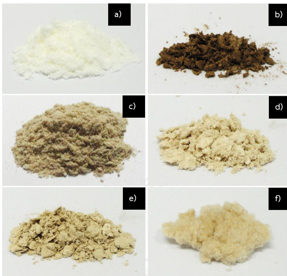
รูปที่ 4.31 ภาพถ่ายของ a) เคราตินทางการค้า และสารสกัดหยาบเคราตินที่สกัดด้วยสารรีดิวซ์ต่างกัน b) ไม่มีสารรีดิวซ์ (UT) c) 2-เมอร์แคปโทเอทานอล (Shindai) d) ไทโกลโคลิกแอซิด pH 2 (TA2) e) ไทโกลโคลิกแอซิด pH 8.5 (TA8.5) และ f) 1,2-อีเทนไดไธออล (EDT)
