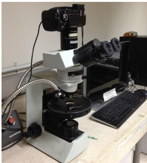
รูปที่ 3.8 กล้องจุลทรรศน์แบบแสง ของบริษัท OLYMPUS รุ่น OM BH2-UMA
