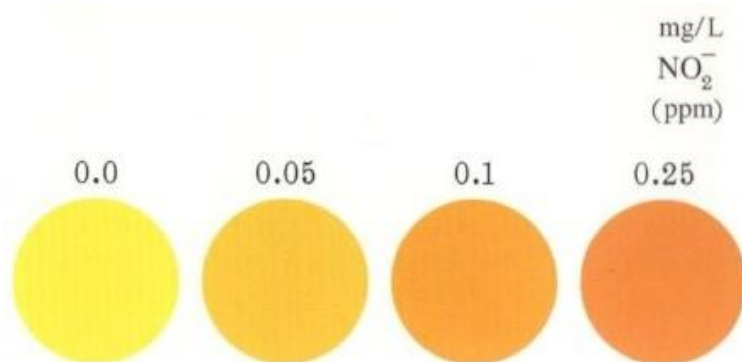
รูปที่ ค.2 สีมาตรฐานสำหรับวัดปริมาณไนไตรท์ใช้ชุดตรวจสอบปริมาณไนไตรท์บริษัท AQUA-VBC ประเทศไทย
