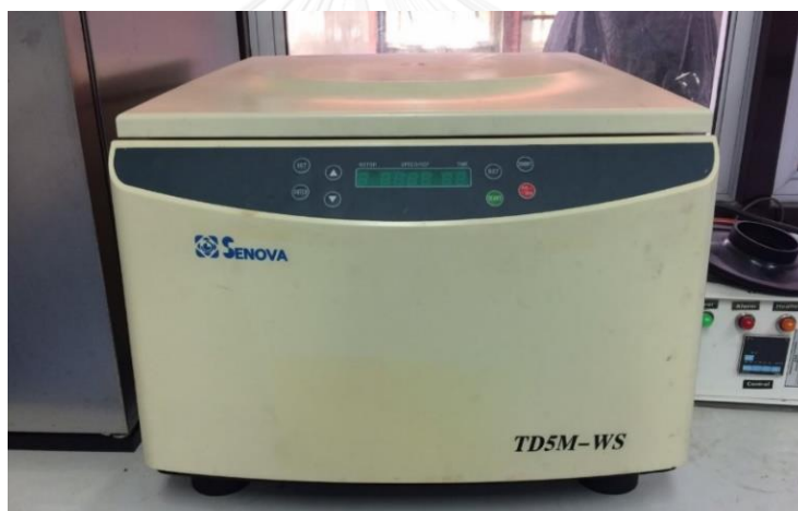
รูปที่ 3.1 เครื่องปั่นเหวี่ยงยี่ห้อ Med inter รุ่น Senova TD5M-WS
