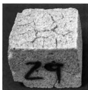
รูปที่ 4.9 ชิ้นงานหลังเผาเปรียบเทียบการล้างและไม่ล้างส่วนผสมก่อนการขึ้นรูป
