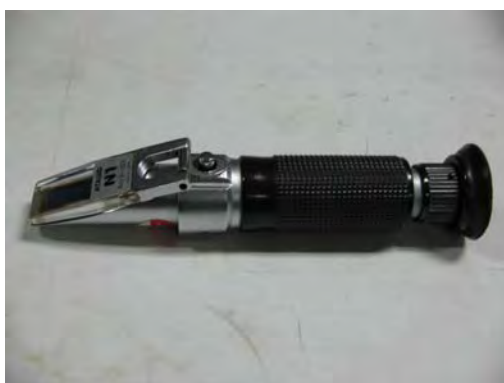
รูปที่ ๓.4: Hand refractometer ที่ใช้ในการทดลอง ที่มา: ยูวลักษณ์, 2548
