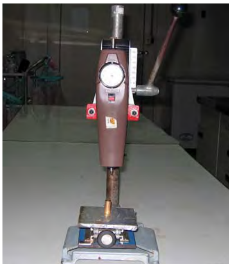
รูปที่ ๓.3: เครื่องมือวัดความแน่นเนื้อ และขนาดหัววัดแรงกดขนาด 2, 5, 8 และ 10 มิลลิเมตร ที่มา: ยูวลักษณ์, 2548
