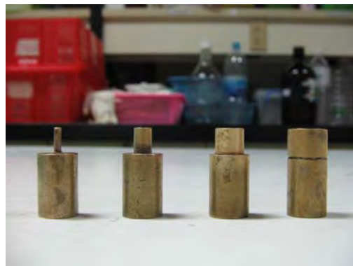
รูปที่ ๓.3: เครื่องมือวัดความแน่นเนื้อ และขนาดหัววัดแรงกดขนาด 2, 5, 8 และ 10 มิลลิเมตร ที่มา: ยูวลักษณ์, 2548
