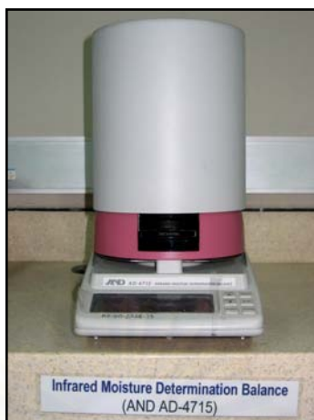
รูปที่ 3.7 เครื่องชั่งน้ำหนักระบบอินฟราเรด
