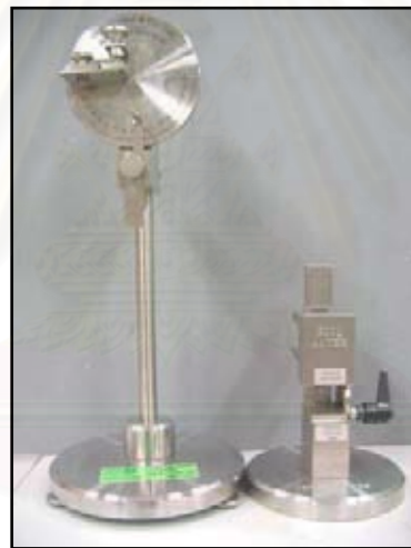
รูปที่ 3.11 เครื่องทดสอบของศาการคืนตัวต่อการยับของผ้า
