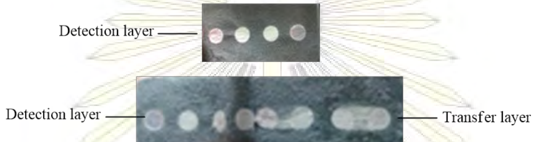
รูปที่ 4.3.3.1 แสดงผลการทดลองการไหลย้อมกับระหว่างชั้นของสารสีย้อมในชั้นต่างๆ
