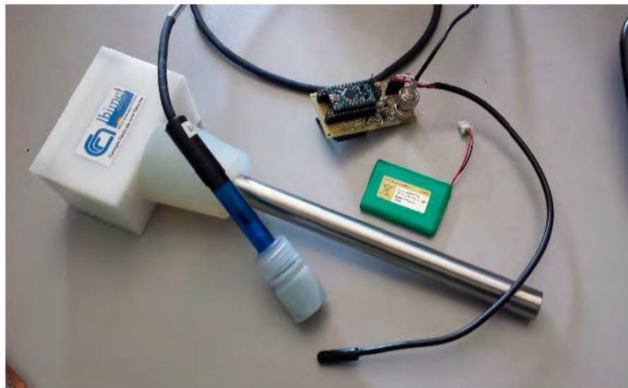
รูปที่ 1.8 โมดูลเซนเซอร์สำหรับวัดค่าความเป็นกรด-เบส (6)
