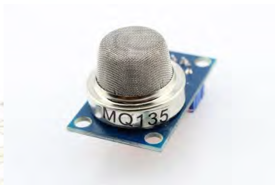
รูปที่ 3.2 โมดูลแก๊สเซนเซอร์ รุ่น MQ-135
