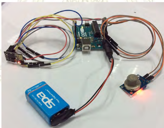
รูปที่ 3.17 การต่อแหล่งจ่ายไฟฟ้าให้กับไมโครคอนโทรลเลอร์ Arduino
