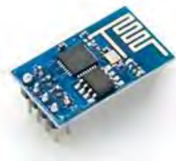
รูปที่ 2.9 ตัวอย่างโมดูลไร้สาย ขนาดประมาณ 14.3 × 24.8 มิลลิเมตรและพอร์ตที่เชื่อมต่อ
