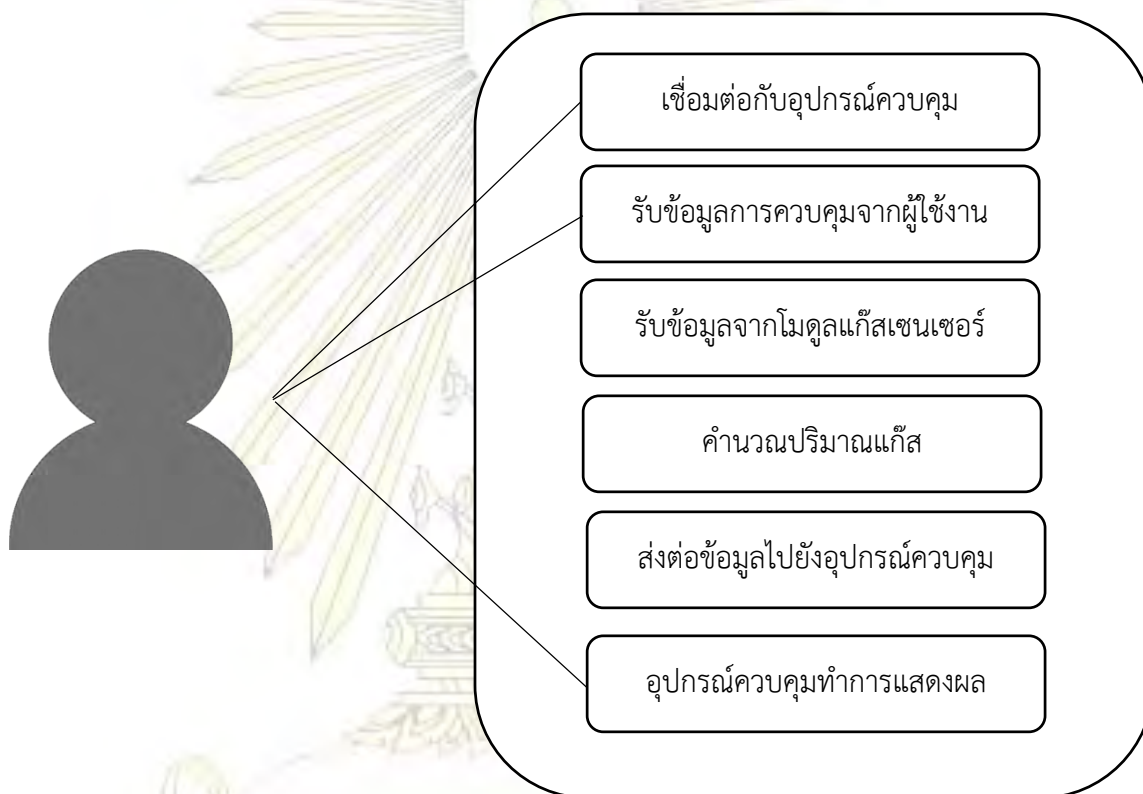
รูปที่ 3.10 แผนภาพยูสเคส ของระบบสำหรับควบคุมอุปกรณ์ติดตามคุณภาพอากาศระยะไกลแบบเรียลไทม์
