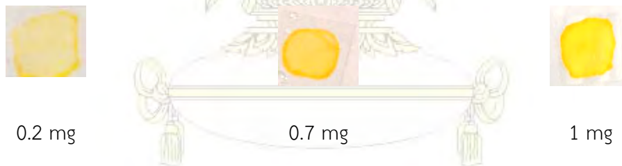
รูปที่ 3.1 ลักษณะแผ่นเมมเบรนที่ปริมาณ PAN ต่าง ๆ
