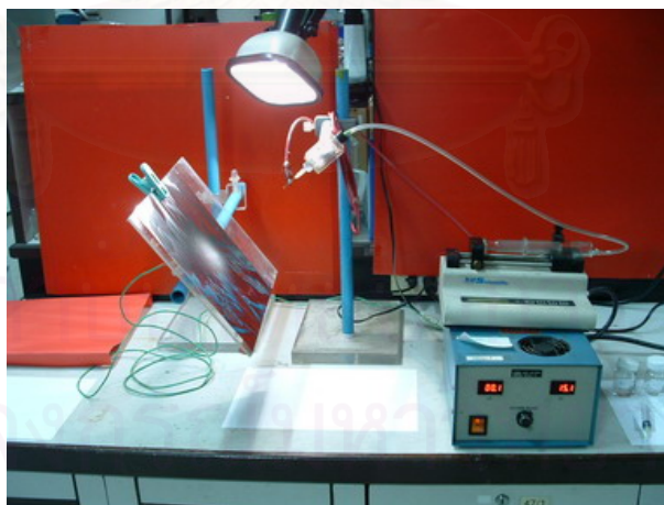
รูปที่ 5. การจัดอุปกรณ์ในกระบวนการปั่นเส้นใยด้วยไฟฟ้าสถิต
