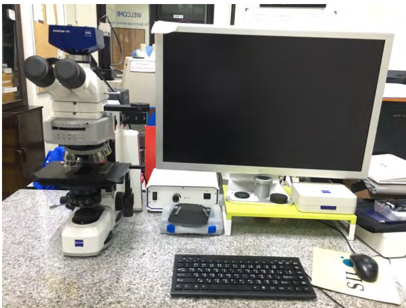
รูปที่ 3.6 บันทึกภาพผลึกด้วยกล้องจุลทรรศน์ห้องปฏิบัติการ ยี่ห้อ Carl Zeiss รุ่น Axio Scope.A1
