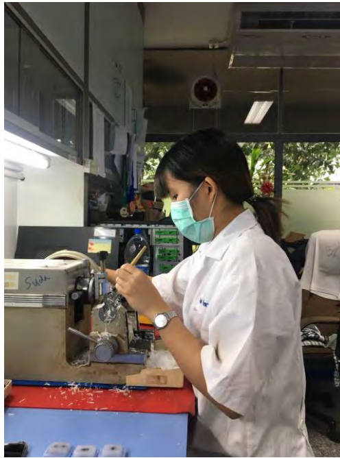
ภาพที่ 3 การตัดพาราฟินบล็อกเป็นแผ่น section
