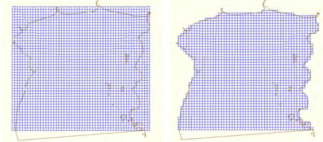
รูปที่ 3.2 รูปแสดงกริดรูปสี่เหลี่ยมจัตุรัส (ซ้าย) กริดรูปร่างจริง (ขวา)
