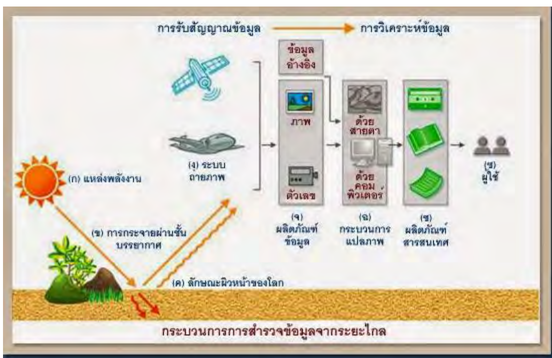
รูปที่ 2. กระบวนการและองค์ประกอบการสำรวจระยะไกล
