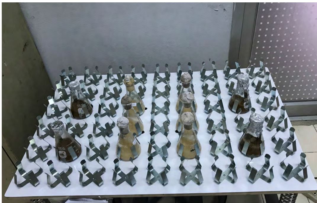
รูปที่ 4.1 กระชายบดละเอียดในเอทานอล 95% บนเครื่องเขย่าที่ความเร็ว 800 รอบต่อนาที
