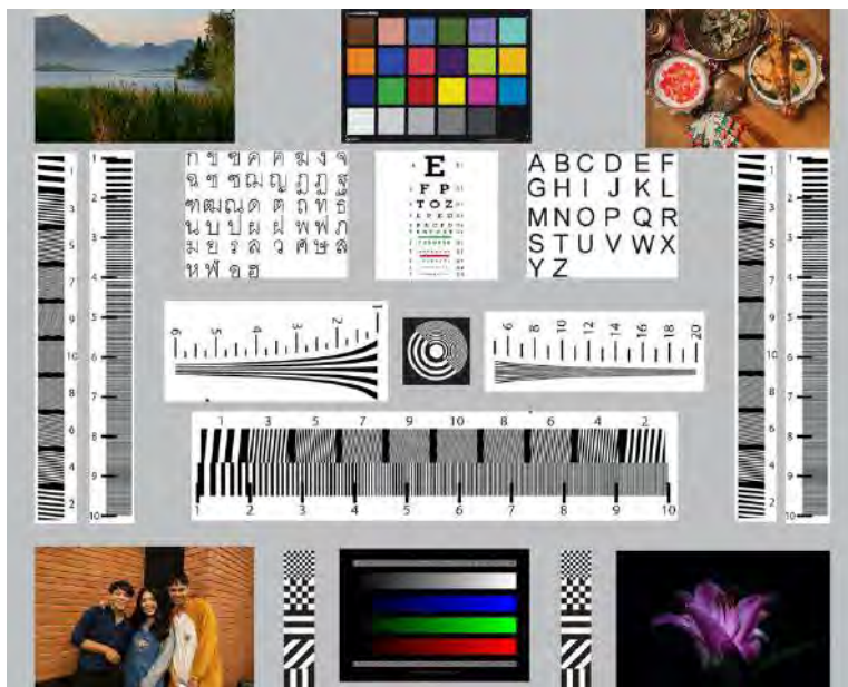
ภาพ 3.24 Test Chart ที่ทำการขยายขนาดภาพจากลดลง 2 เท่าเป็น 1 เท่า ด้วยโปรแกรม Preview
