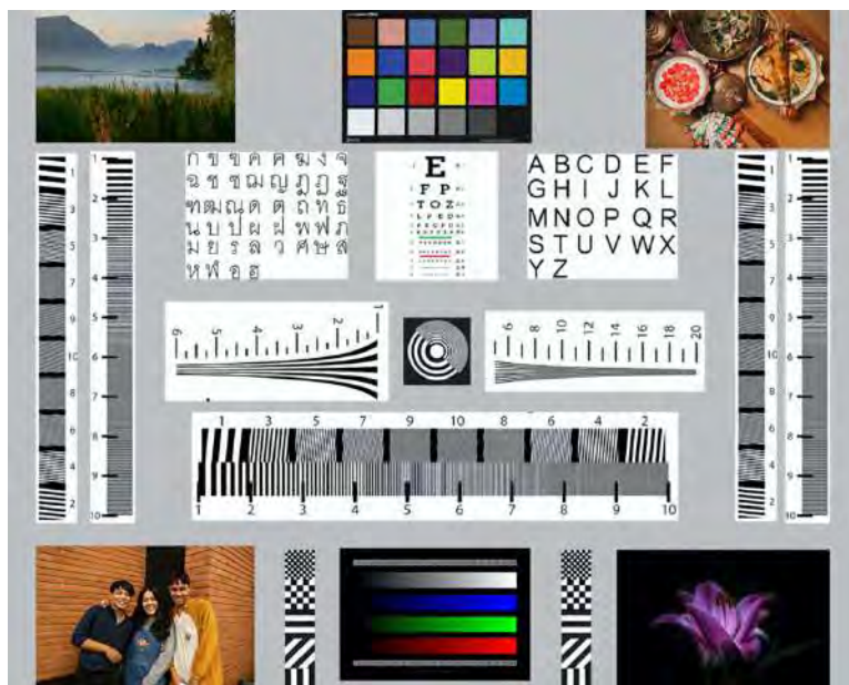
ภาพ 3.31 Test Chart ที่ทำการขยายขนาดภาพจากลดลง 4 เท่าเป็น 1 เท่า ด้วยโปรแกรม Remini
