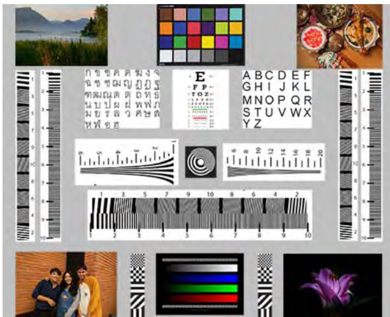
ภาพ 3.22 Test Chart ที่ทำการขยายขนาดภาพจากลดลง 6 เท่าเป็น 1 เท่า Resample แบบ Bilinear
