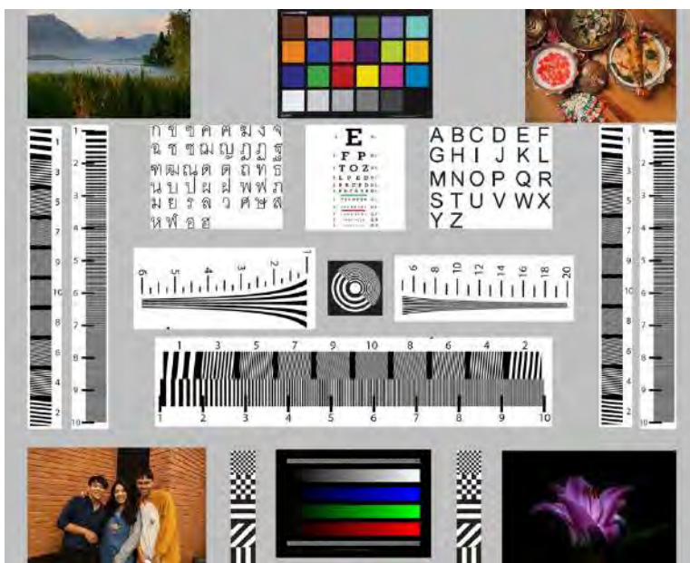
ภาพ 3.11 Test Chart ที่ทำการขยายขนาดภาพจากลดลง 2 เท่าเป็น 1 เท่า Resample แบบ Bicubic
