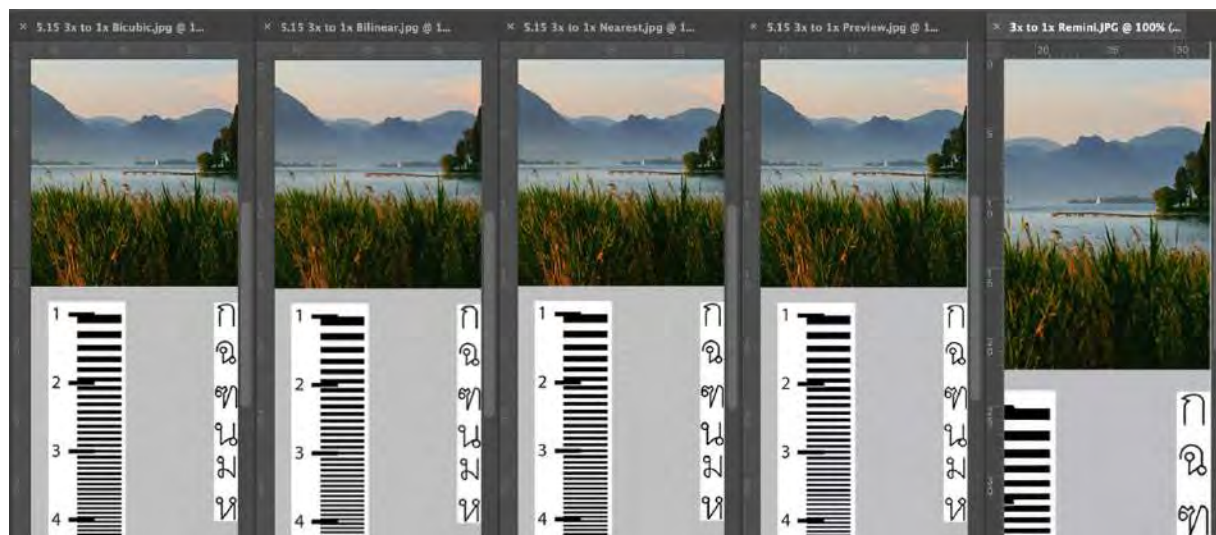
ภาพ 4.9 ภาพวิวทิวทัศน์ที่ย่อภาพเหลือ 1500*1200 (5.15 เมกะพิกเซล) และขยายภาพเป็น 3000*2400 (20.6 เมกะพิกเซล) ขยายภาพที่ 100 %
