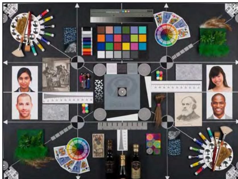
ภาพ 3.1 Test Chart ที่นำมาเป็นอ้างอิงในการออกแบบ Test Chart
