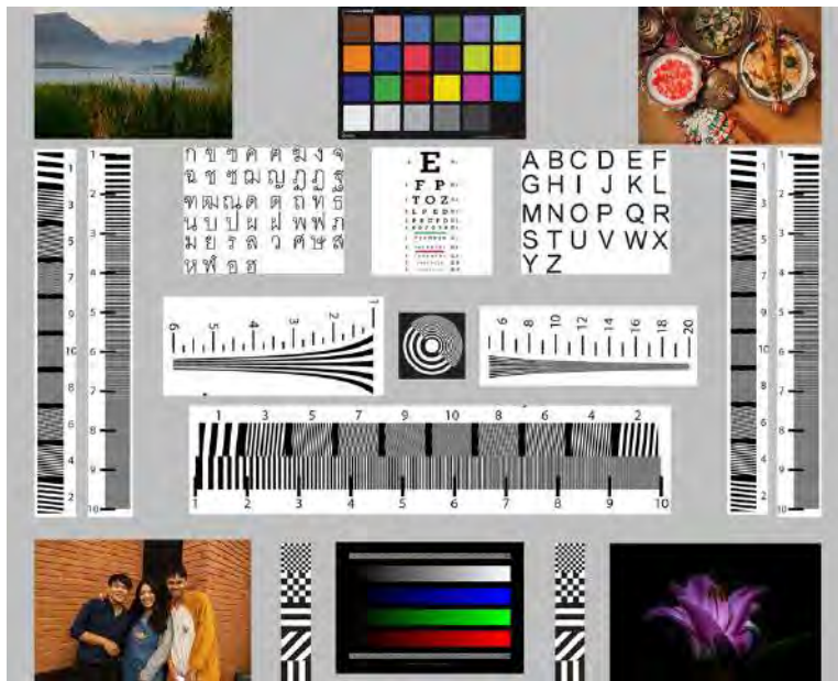
ภาพ 3.12 Test Chart ที่ทำการขยายขนาดภาพจากลดลง 3 เท่าเป็น 1 เท่า Resample แบบ Nearest Neighbor
