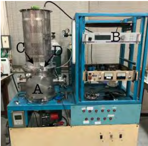
รูปที่ 3.2.6 เครื่องให้กำเนิดพลาสมา (Plasma reactor) (ซ้าย), Diagram ของ ระบบRadio-Frequency inductively coupled plasma reactor (ขวา) [21]
