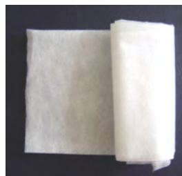
รูปที่ 2.9 แสดงโครงสร้างโมเลกุลพอลิพรอพิลีนและแผ่นเส้นใยพอลิพรอพิลีนไม่สานทอ
