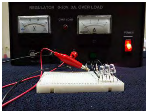
รูปที่ 3.2 : นำหลอดอินฟราเรดที่ผ่านการวัดมาต่อวงจรและใส่ตัวต้านทาน 100 โอห์ม
