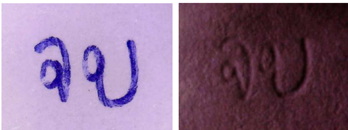
รูปที่ ข.5 : ฝั่งซ้ายคือภาพที่ถ่ายด้วยแสงขาว และฝั่งขวาคือภาพที่ถ่ายด้วยการให้รังสีอินฟราเรดจากด้านซ้าย
