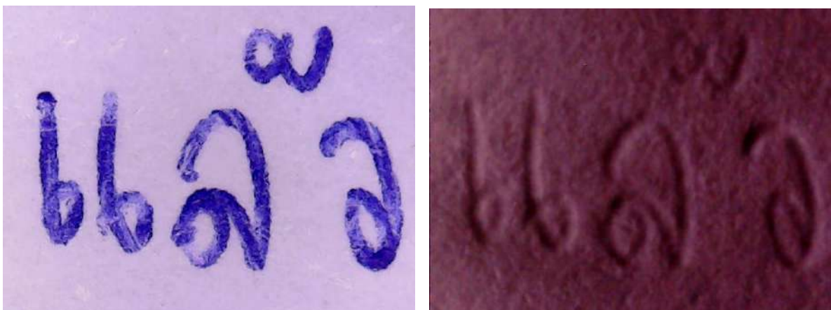
รูปที่ ข.13 : ฝั่งซ้ายคือภาพที่ถ่ายด้วยแสงขาว และฝั่งขวาคือภาพที่ถ่ายด้วยการให้รังสีอินฟราเรดจากด้านซ้าย
