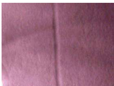
รูปที่ 3.4ก ให้รังสีอินฟราเรดจากด้านซ้ายของกระดาษระยะห่างของหลอดอินฟราเรดกับจุดศูนย์กลางของ กระดาษอยู่ที่ 0.6 เซนติเมตร
