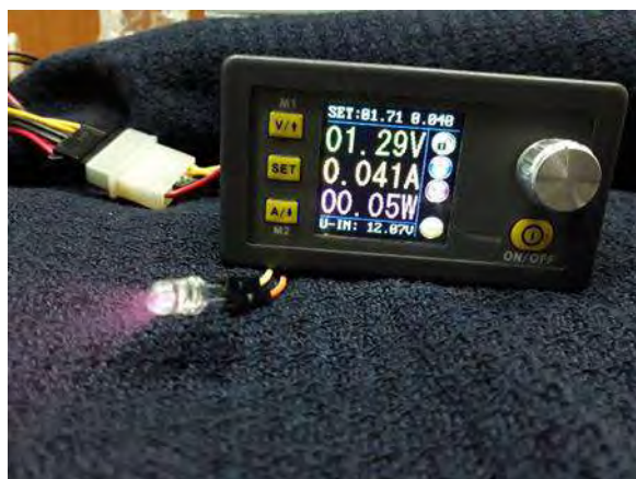
รูปที่ 3.1 : ใช้แหล่งจ่ายไฟปรับค่าได้ ในการกำหนดค่ากระแสและวัดค่าความต่างศักย์ของหลอดอินฟราเรด
