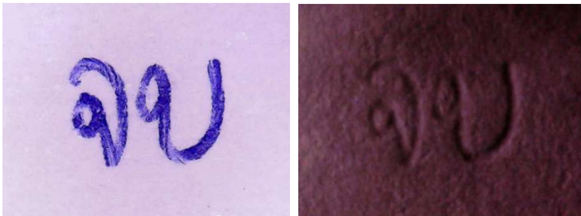
รูปที่ ข.3 : ฝั่งซ้ายคือภาพที่ถ่ายด้วยแสงขาว และฝั่งขวาคือภาพที่ถ่ายด้วยการให้รังสีอินฟราเรดจากด้านซ้าย
