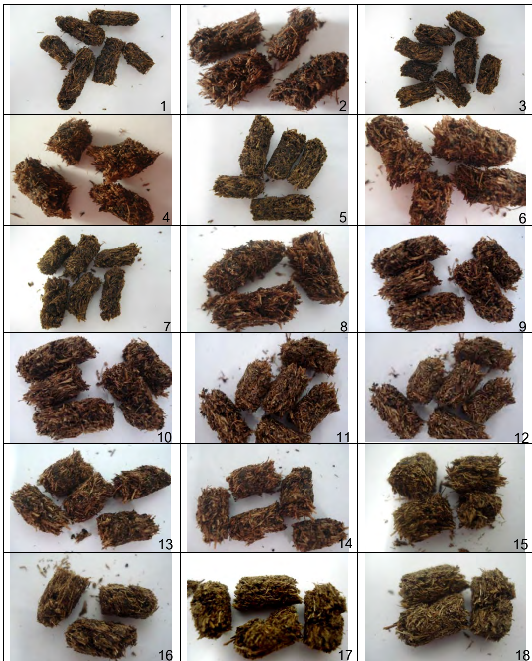
รูปที่ ง - 2 แสดงลักษณะของเชื้อเพลิงอัดเม็ดจากเส้นใยปาล์มขนาดอนุภาค 0.5 – 1.0 มม. ใช้น้ำ และของเสี้ยกลีเซอรอลเป็นตัวประสาน
