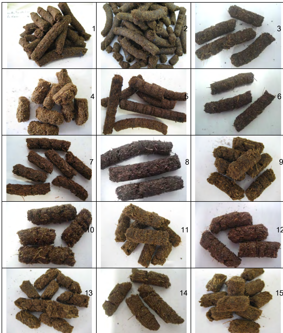
รูปที่ ง - 1 ลักษณะของเชื้อเพลิงอัดเม็ดจากเส้นใยปาล์มขนาดอนุภาค < 0.5 มม. ใช้น้ำและของเสี้ยกลีเซอรอลเป็นตัวประสาน
