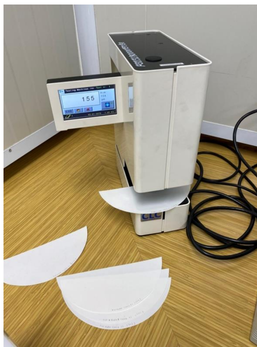
ภาพที่ ก-6 เครื่องวัดความหนาของกระดาษ (Thickness tester)
