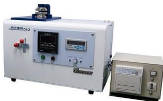
ภาพที่ ก-7 เครื่องวัดความเรียบ (Smoothness tester)
