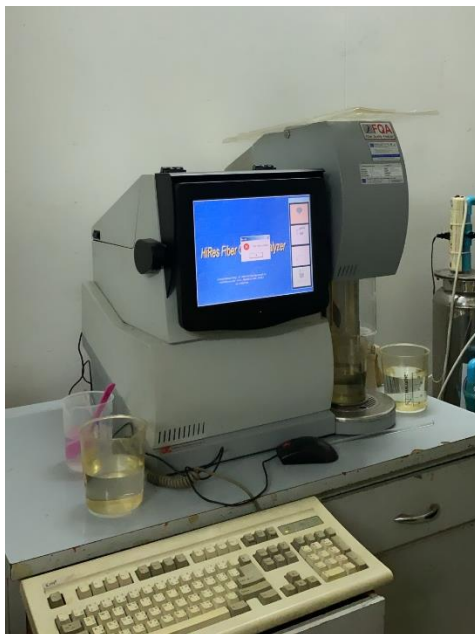
ภาพที่ ก-5 เครื่องวัดสัณฐานวิทยาของเส้นใย (Fiber Quality Analyzer)
