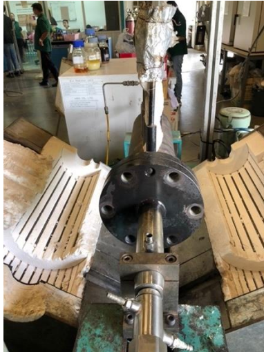
รูปที่ 3.8 การบรรจุขวดยาคุลท์และตัวเร่งปฏิกิริยาในเครื่องปฏิกรณ์
