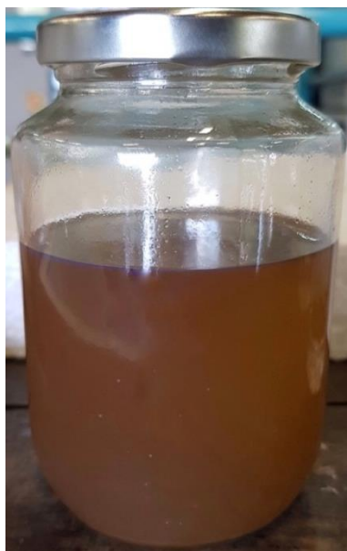
รูปที่ 10 น้ำมันจากการไพโรไลซิสขวดยาคุลท์
