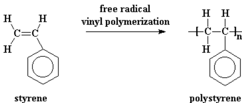
รูปที่ 2.1 ปฏิกิริยาพอลิเมอไรเซชันของสไตรีนเป็นพอลิสไตรีน [6]
