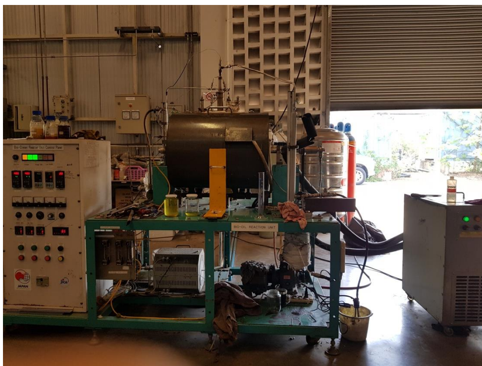
รูปที่ 3.1 เครื่องปฏิกรณ์แบบกึ่งกะ ขนาด 3 ลิตร (Semi-batch reactor)
