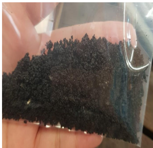
รูปที่ 11 กากน้ำมันที่เหลือจากการไพโรไลซิสขวดยาคุลท์
