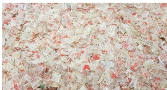
รูปที่ 3.6 ขวดยาคูลท์ขนาดไม่เกิน 1x1 เซนติเมตร
