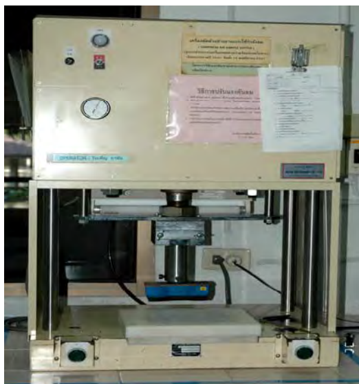
รูปที่ 3.6 เครื่องตัดตัวอย่างยางแบบใช้กำลังลม
