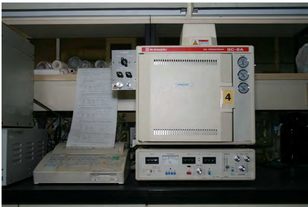
รูปที่ ง.6: เครื่อง Gas chromatography (GC-8A) ที่ใช้ในการตรวจสอบวิเคราะห์ก๊าซ ของฝ่ายปฏิบัติการวิจัยและเรือนปลูกพืชทดลอง มหาวิทยาลัยเกษตรศาสตร์ วิทยาเขตกำแพงแสน
