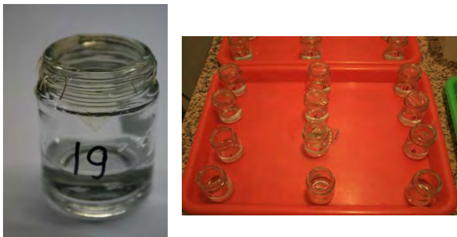
รูปที่ 3.2 ภาพการทดสอบความสามารถในการแพร่ผ่านของไอน้ำ (WVTR) ในห้องควบคุมความอุณหภูมิ 27 องศาเซลเซียส และความชื้น 70%
