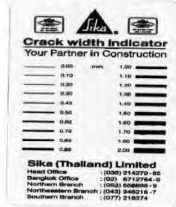
หมายเหตุ : ใช้แผ่น Crack width indicator ในการวัดความกว้างของรอย Crack
