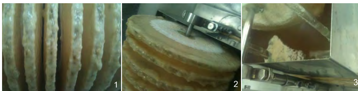
แสดงการติดและการเจริญของเชื้อบนแผ่นหมูนในชั่วโมงที่ 92
