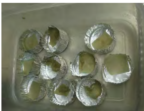
รูปที่ 4.29 แสดงชั้นของผ้าชนิดต่างๆขนาด 1x1 นิ้ว ก่อนนำไปอบแห้ง
