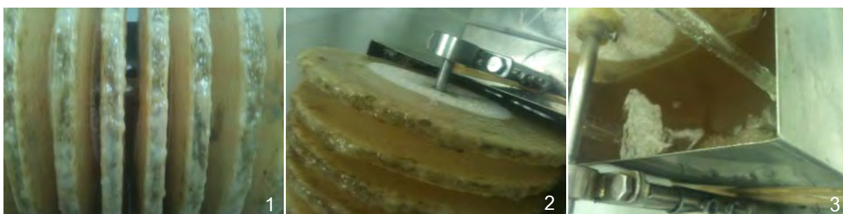
แสดงการติดและการเจริญของเชื้อบนแผ่นหมุนในชั่วโมงที่ 56
