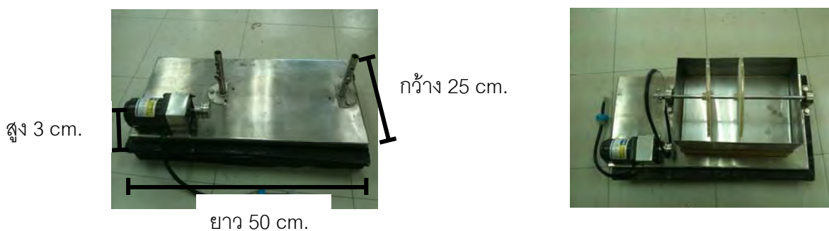
รูปที่ 4.4 แสดงฐานรองถังหมักและมอเตอร์ที่ใช้ปรับความเร็วในการหมุนของแผ่นหมุน
