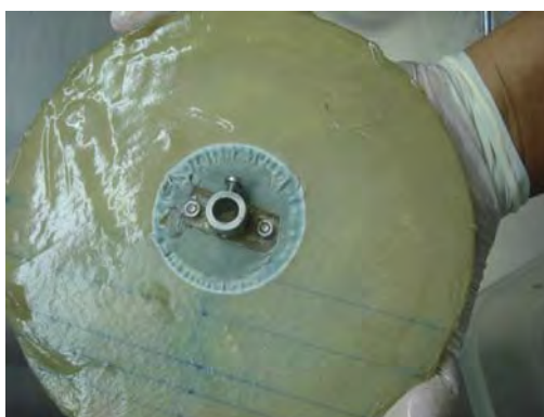
รูปที่ 4.28 แสดงการเกาะติดของเชื้อบนแผ่นหมันชีวภาพที่ติดด้วยผ้าลินิน
