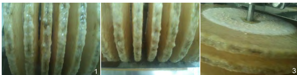
แสดงการติดและการเจริญของเชื้อบนแผ่นหมูนในชั่วโมงที่ 80
