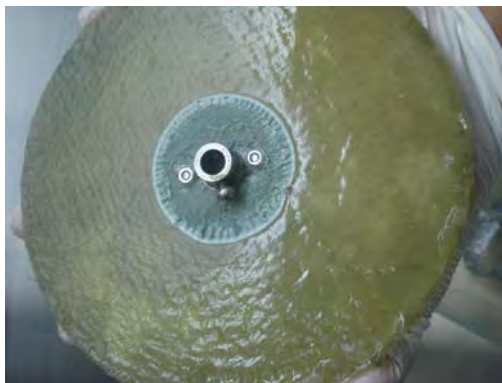
รูปที่ 4.27 แสดงการเกาะติดของเชื้อบนแผ่นหมันชีวภาพที่ติดด้วยผ้าขาวบาง
