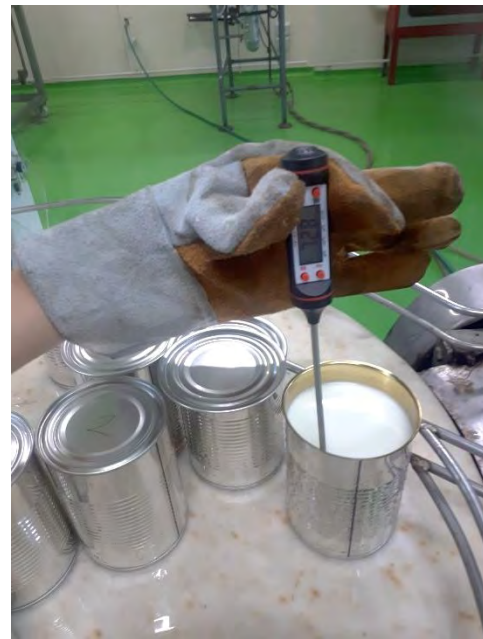
รูปที่ ง.2 ขั้นตอนการไล่อากาศ (Exhausting) ด้วยการบรรจุแบบร้อน (Hot fill) ก่อน Sterilization
