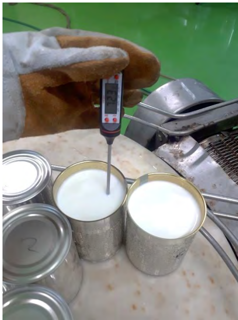
รูปที่ ง.2 ขั้นตอนการไล่อากาศ (Exhausting) ด้วยการบรรจุแบบร้อน (Hot fill) ก่อน Sterilization
