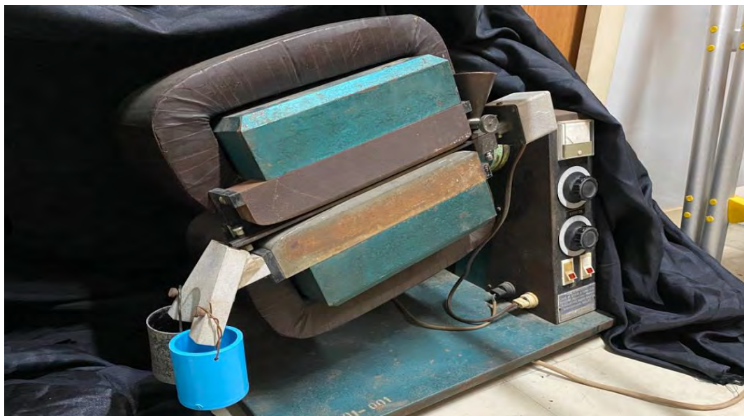
รูป 2.9. เครื่องแยกแม่เหล็ก isodynamic magnetic separator ภาควิชาธรณีวิทยา จุฬาลงกรณ์มหาวิทยาลัย
