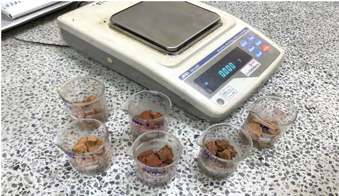
รูป 2.6. การหาร้อยละของปริมาณน้ำในตัวอย่าง โดยการชั่งและบันทึกค่าน้ำหนักก่อนอบและหลังอบ
