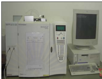
รูปที่ 3.7 เครื่องแก๊สโครมาโตกราฟ ยี่ห้อ Thermofinigan รุ่น Trace GC 2000
