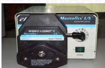
รูปที่ 3.5 ปั๊มดูดจ่ายสารเคมี
