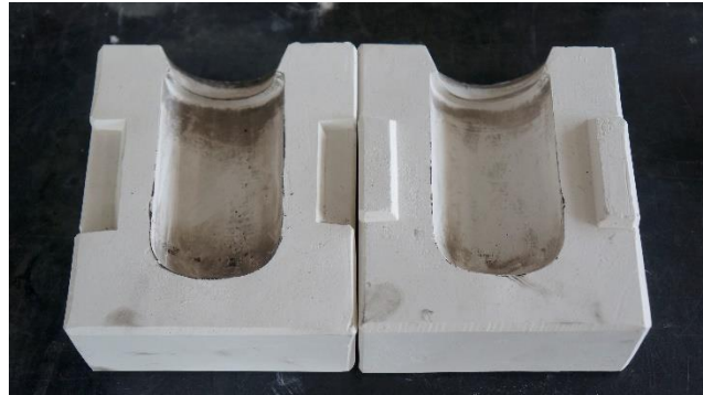
รูปที่ 3.8 แม่พิมพ์ปูนพลาสติกที่ยังไม่ได้ประกบ
