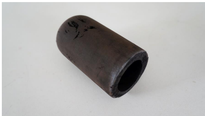
รูปที่ 4.28 ชิ้นงานตัวอย่างก่อนเผา ของไส้กรองเซรามิกเชิงประกอบของถ่านแกลบกำมันต์/ซีโอไลต์/ซิงก์ออกไซด์ ใช้เวลาบดผสม 15 นาที เวลาในการหล่อแบบ 3 ชั่วโมง
