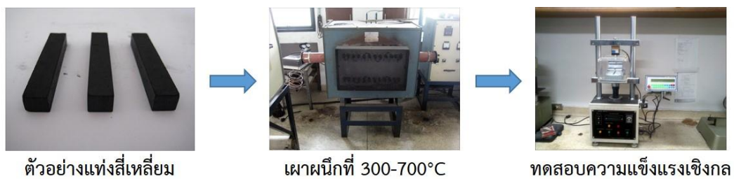
รูปที่ 2.14 การกักมันต์และทดสอบความแข็งแรงเชิงกล
