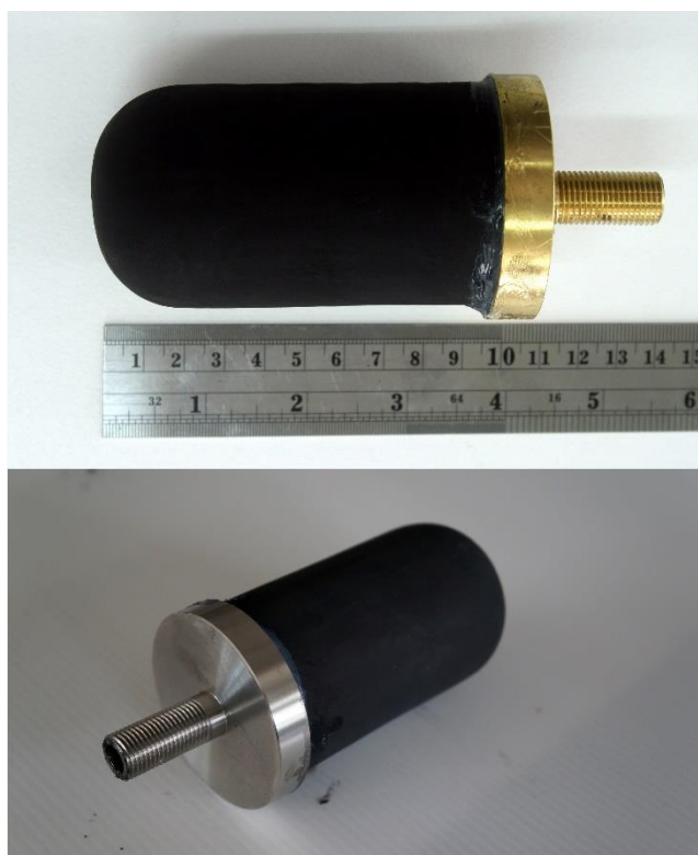
รูปที่ 4.9 ไส้กรองเซรามิกเชิงประกอบของถ่านกัมมันต์/ซีโอไลต์/ซิงก์ออกไซด์ ที่ติดถูกทองเหลือง หรือสแตนเลส
