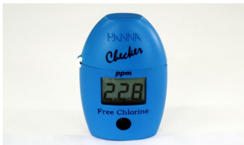
รูปที่ 3.15 เครื่องวัดคลอรีนอิสระ HANNA (Model:HI-701)
