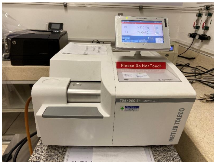
รูปที่ 3.16 เครื่องเทอร์โมกราวิเมตริกแอนาไลเซอร์
