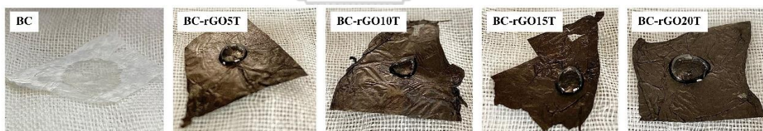
รูปที่ 4.27 การทดสอบความสามารถในการเปียกน้ำบนพื้นผิวของฟิล์มแบคทีเรียเซลลูโลสที่ย้อมด้วยรีดิวซ์แกรฟีนออกไซด์
