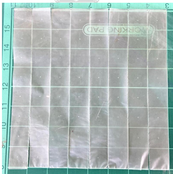
รูปที่ 3.23 ลักษณะชิ้นงานสำหรับทดสอบสมบัติทนแรงดึง
