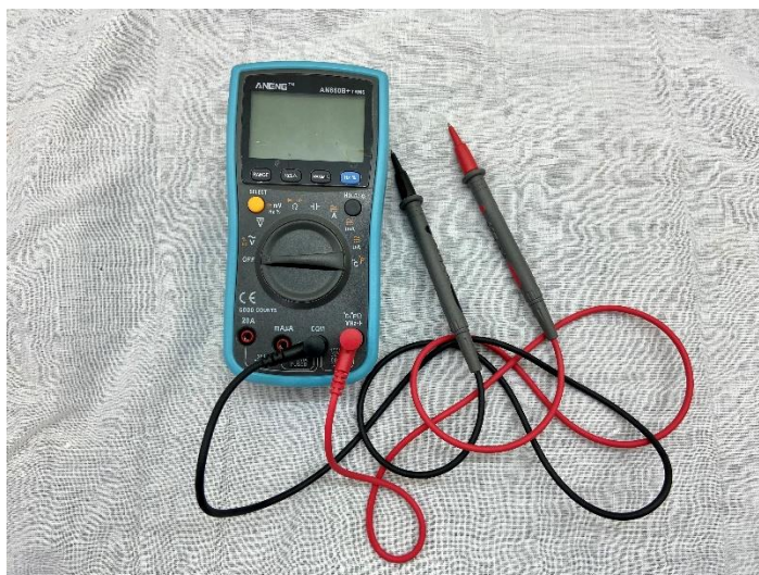
รูปที่ 3.26 เครื่องมัลติมิเตอร์แบบดิจิทัล (Digital Multimeter)
