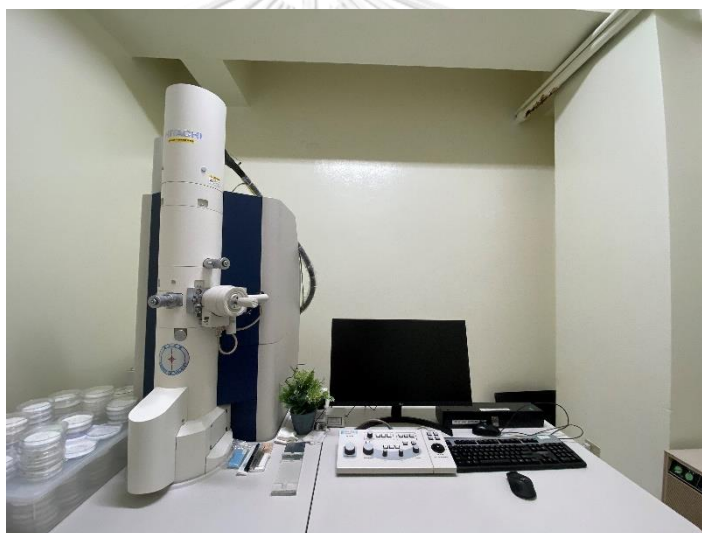
รูปที่ 3.21 กล้องจุลทรรศน์อิเล็กตรอนแบบส่องผ่าน (Transmission electron microscope; TEM)
