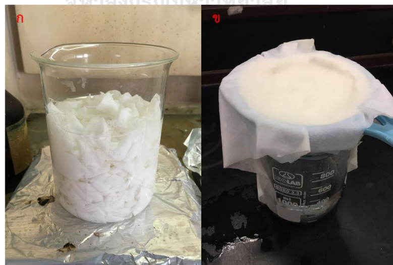
รูปที่ 3.7 การแช่เศษผ้าฝ้ายในกรดไฮโดรคลอริก (ก) และการกรองและล้างด้วยน้ำ DI ผ่านผ้าขาวบาง (ข)
