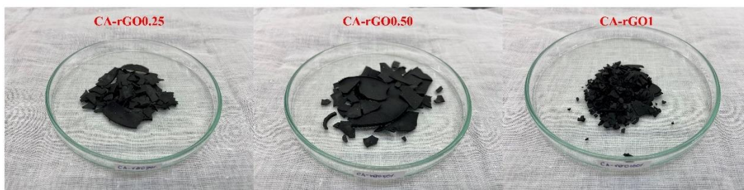
รูปที่ 4.6 ลักษณะของฟิล์มฐานเซลลูโลส/รีดิวซ์แกรฟีนออกไซด์ที่เตรียมได้
