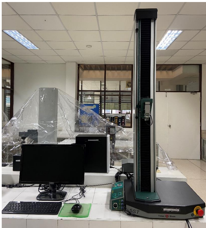
รูปที่ 3.22 เครื่องทดสอบอเนกประสงค์ (Universal testing machine)
