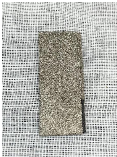
รูปที่ 3.28 ลักษณะของขั้วไฟฟ้าที่เตรียมได้จากฟิล์มแบคทีเรียเซลลูโลส ที่ย้อมด้วยรีดิคซ์แกรฟีนออกไซด์
