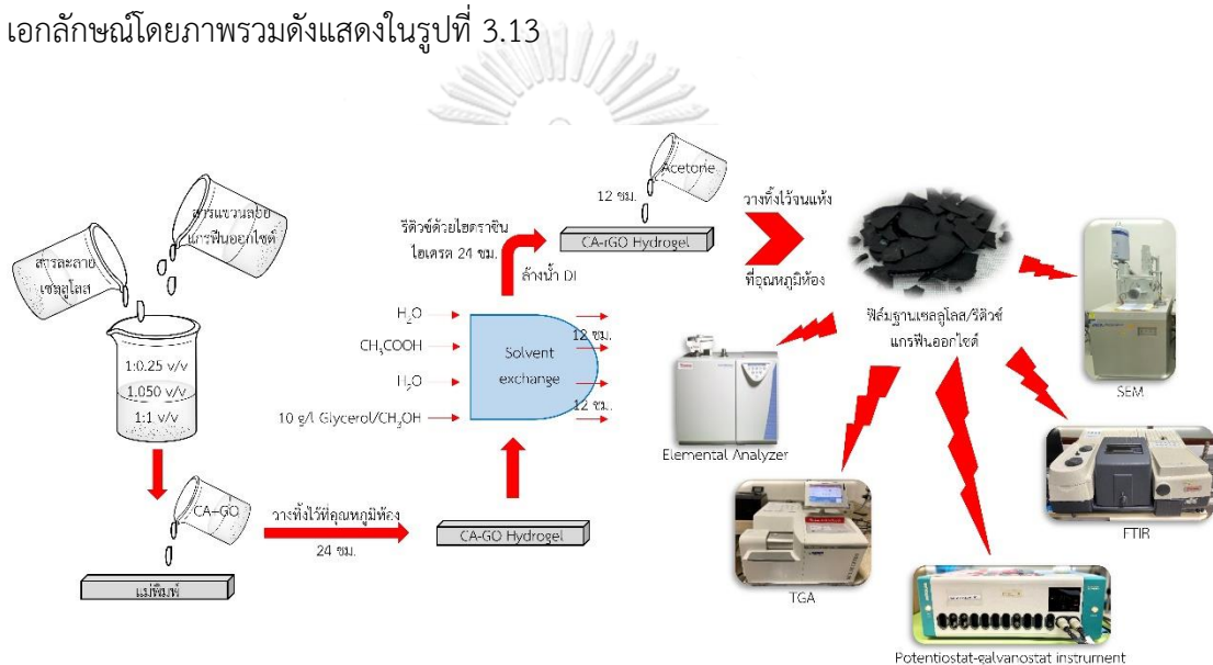
รูปที่ 3.13 ภาพรวมของกระบวนการเตรียมและพิสูจน์เอกลักษณ์ของฟิล์มฐานเซลลูโลส/รีดิวซ์แกรฟีนออกไซด์
