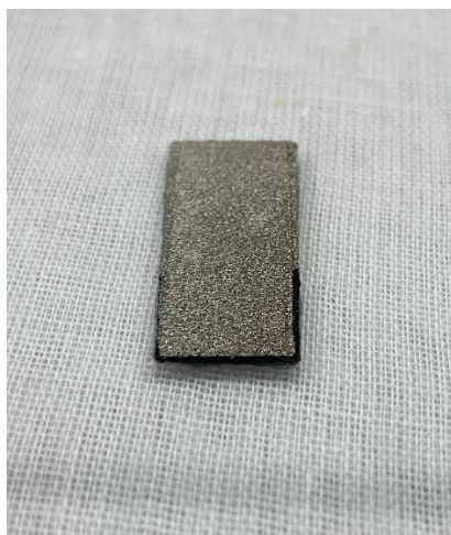
รูปที่ 3.32 ลักษณะของขั้วไฟฟ้าที่เตรียมได้จากฟิล์มแบคทีเรียเซลลูโลสที่ย้อมด้วยพอลิอะนิลีนและรีดิวซ์แกรฟีนออกไซด์
