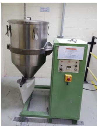
รูปที่ 3.1 เครื่องผสมแบบถังหมุน(Tumbler mixer)
