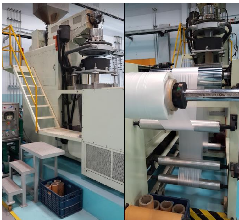
รูปที่ 3.4 เครื่องเป่าฟิล์ม (Film Blowing Machine, A.R. Product Ltd. Part)
