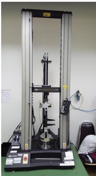
รูปที่ 3.5 เครื่อง Universal tensile testing machine ยี่ห้อ Instron รุ่น 4465
